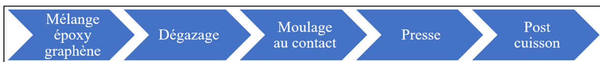
Figure 2.27 Processus de fabrication des plaques CFRP
