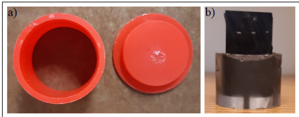
Figure 2.16 a) Moule utilisé, b) échantillon final
