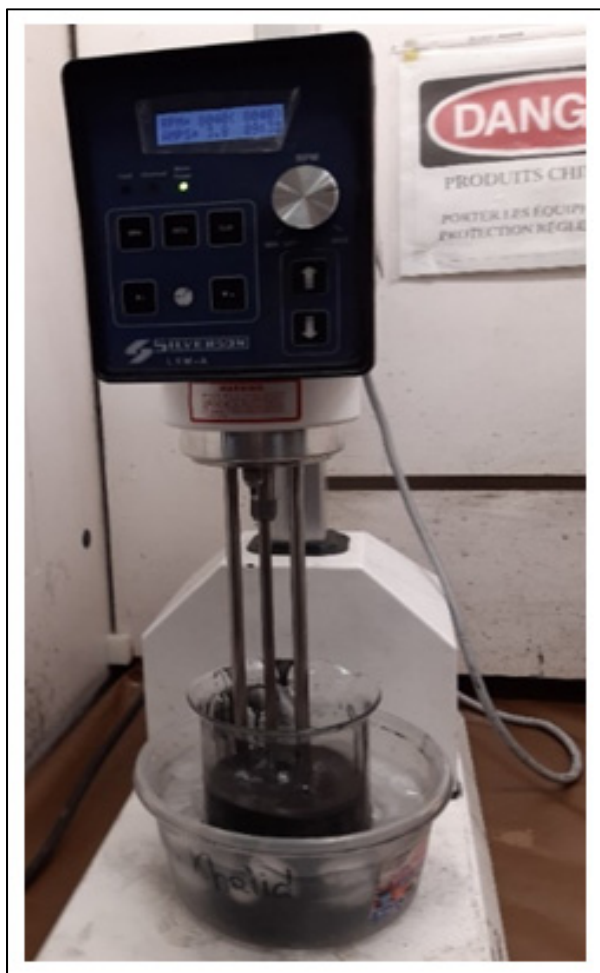
Figure 2.11 Montage final avec le mélangeur la résine modifiée et l'eau avec les glaçons
