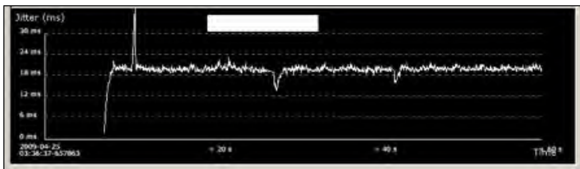
Figure 5.6 La gigue d'une communication IAX avec le codec GSM (ms).
