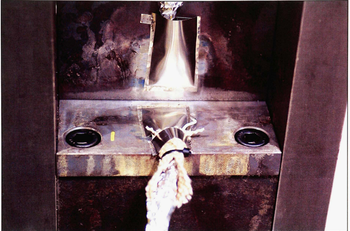
Figure 3.4 Installation des jauges de déformation avant soudage.
