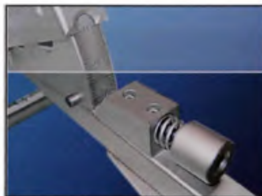
Figure 5.4 Poussoir à ressort calibré situé sur l'assise d'OSCAR SAE.
