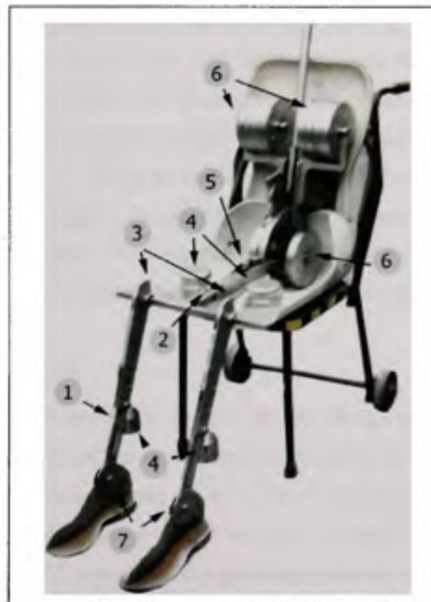
Figure 3.2 Photographie d'une machine tridimensionnelle point H de type OSCAR.
