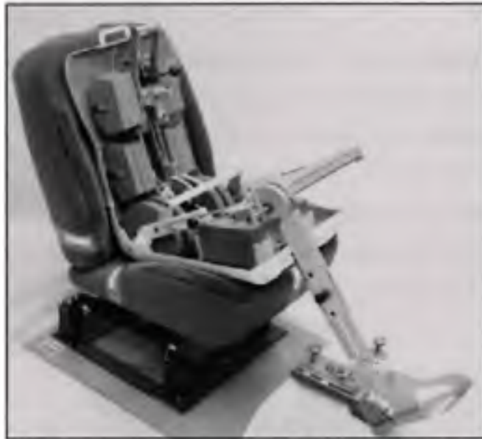
Figure 3.3 Photographie d'une machine tridimensionnelle point H de type ASPECT.
