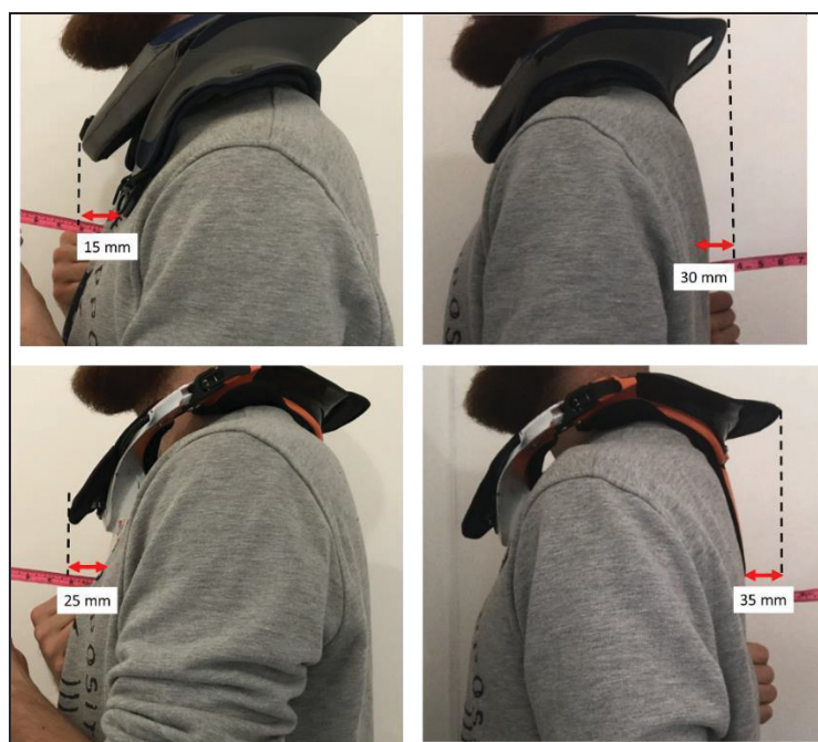
Figure 5-10 Mesure de la distance de dépassement des dispositifs EVS et Leatt Brace pour l'évaluation du critère de dépassement
