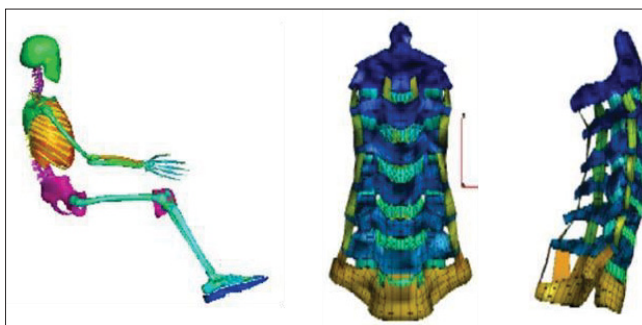
Figure 1-17 Modèle THUMS – Corps humain complet et segment cervical. Adaptée de (Chawla et al., 2005)
