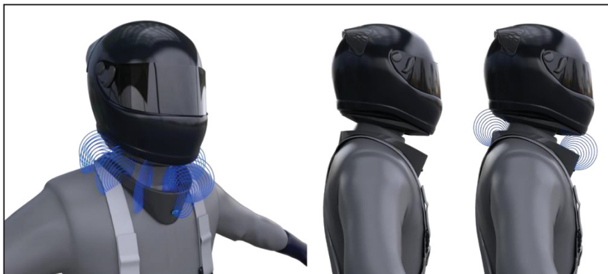
Figure 6-24 Vue isométrique et vue latérale du prototype virtuel « magnétisme inactif » et « magnétisme actif »
