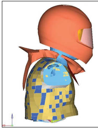
Figure 5-6 Dispositif Leatt Brace assemblé au modèle HUMOS
