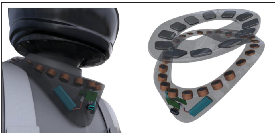
Figure 6-25 Positionnement des composants électroniques, des électro-aimants et des aimants permanents.
