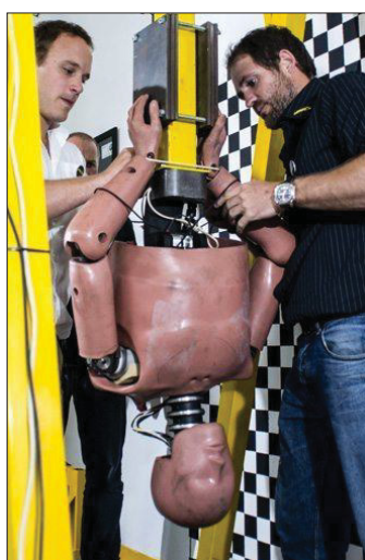
Figure 1-24 Mannequin Hybrid III 50 e percentile chez Leatt – Tirée de ( Leatt Brace website , s. d.)
