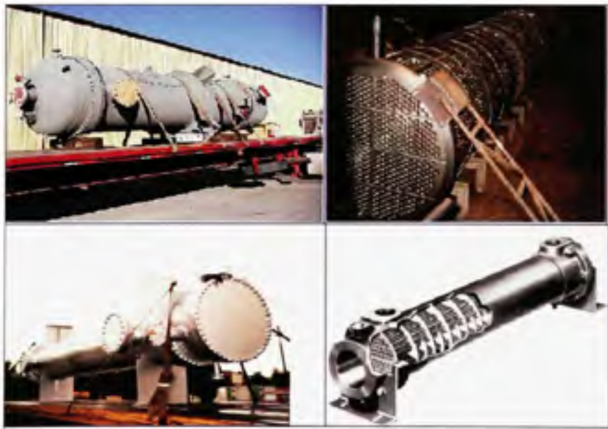
Figure 01 Échangeurs de chaleur du type faisceau et calandre. Tirée de photos de l'Université de Texas, Austin (2006)
