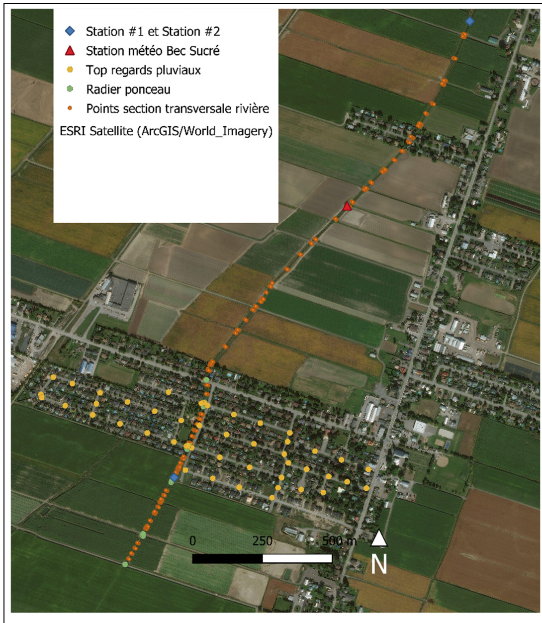
Figure-A II-1 Points du relevé d'arpentage (stations limnimétriques, station météorologique Bec Sucre, dessus des regards pluviaux, radiers des ponceaux, sections transversales de la rivière)
