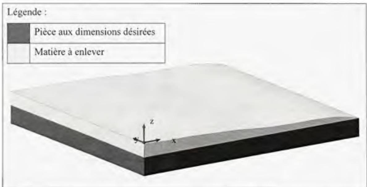
Figure 5.3 Exemple d'un volume d'un seuil obtenu par mesure tridimensionnelle.
