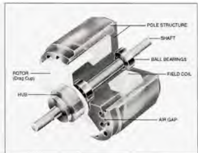
Figure 4.4 Composantes du frein. Tirée de (Magtrol 2010)
