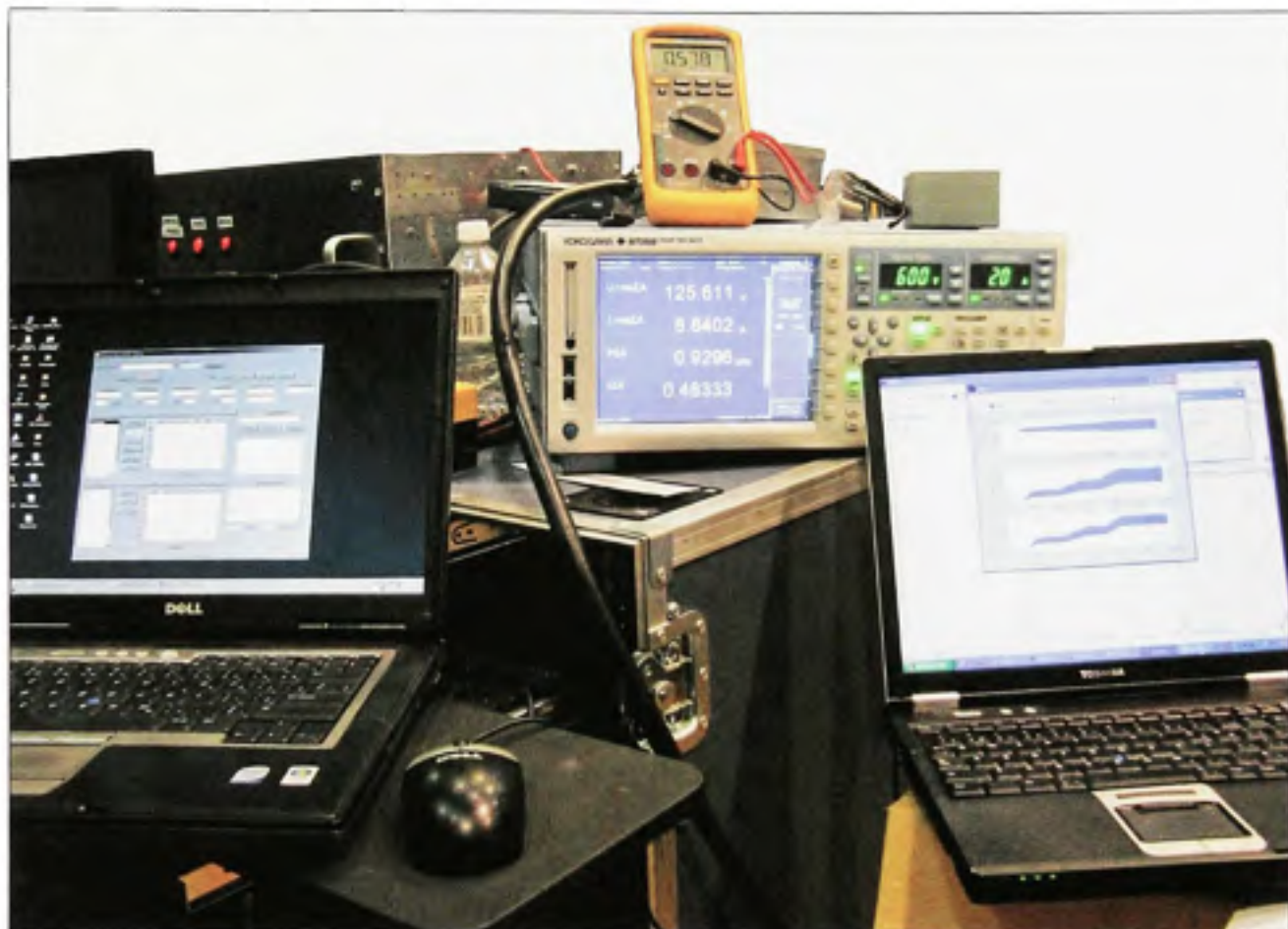
Figure-A I-3 Instruments de mesure du banc d'essai dynamométrique et de l'analyseur de puissance.
