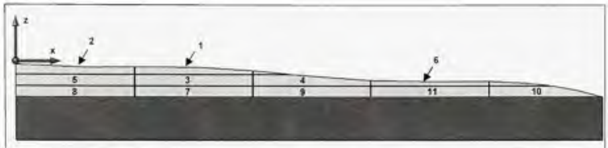
Figure 5.4 Découpage du volume en unité de meulage (ex : 1 mm x largeur de meule).
