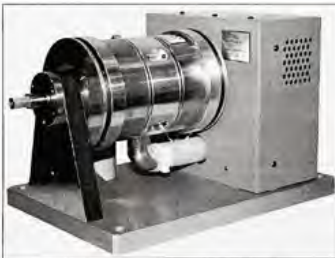
Figure 4.3 Banc essai dynamométrique Magtrol HD-805-8N. Tirée de (Magtrol 2010)
