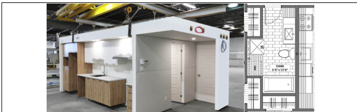
Figure 3.3 Image et plan du système préfabriqué initial Tirée de Fab (2021)
