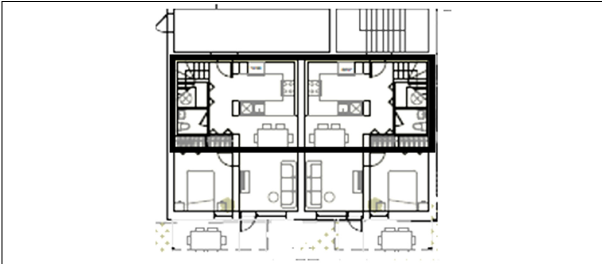
Figure 3.7 Configuration de deux pods multilogement dans un étage Tirée par AR (2019)
