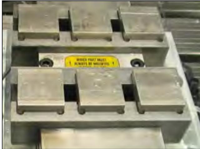
**Figure 3.2 Montage spécial utilisé pour maintenir les pièces.**
