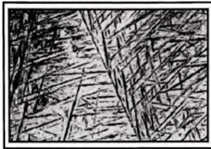
Figure 1.7 Structure martensitique (gr. 1400). (Tiré de Jahazi et Yue, 2001)
