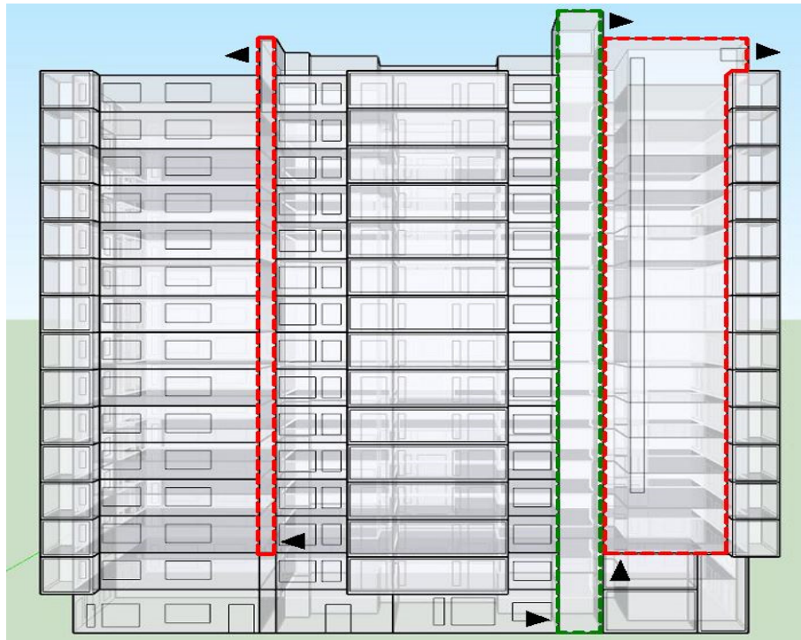
Figure 5.4 Illustre la coupe du principe ventilatoire développé dans le cas d'étude de Terrebonne
