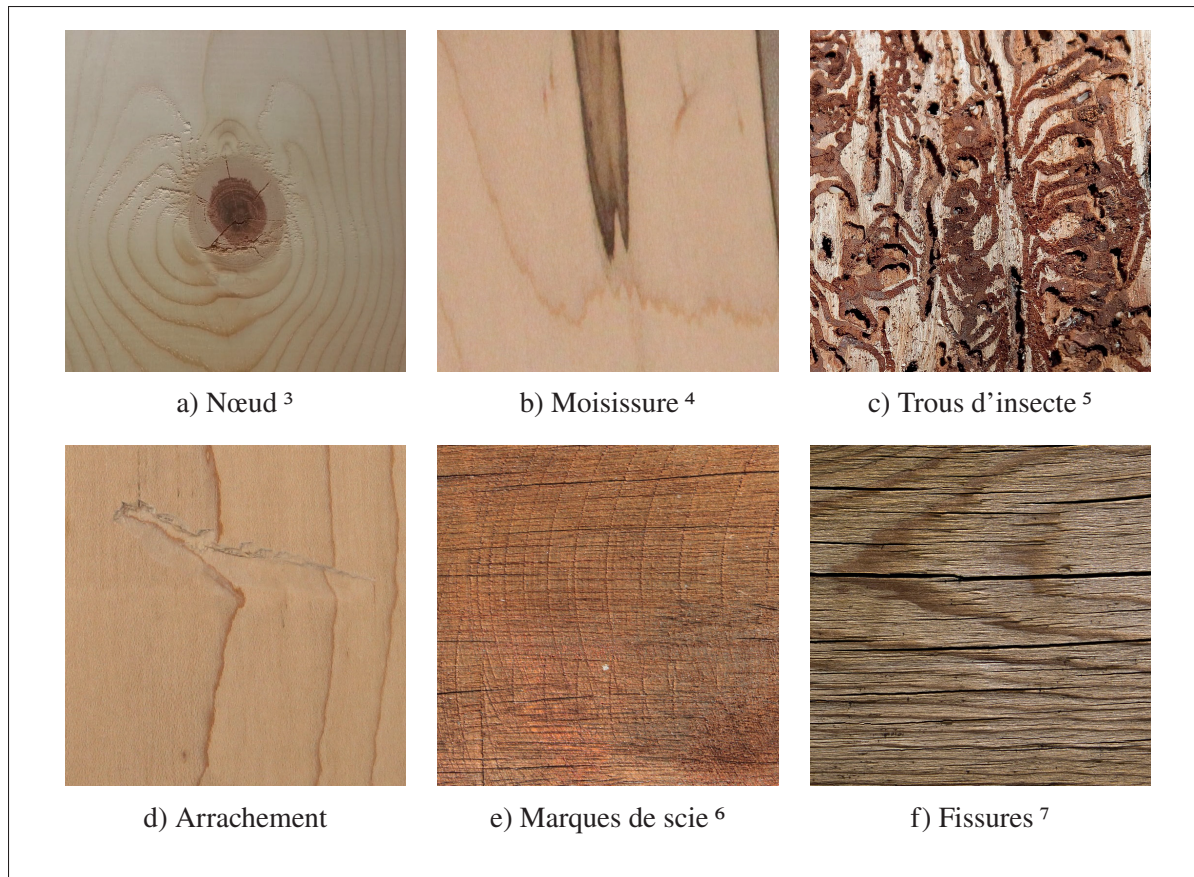
Figure 1.1 Exemples de défauts de surface sur le bois
