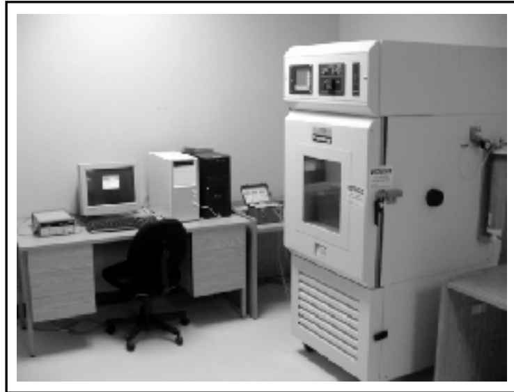
Figure 2.2 Chambre environnementale et système d'acquisition de données.
