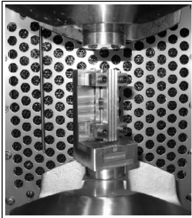
Figure 2.3 Dispositif pour éprouvettes minces (ASTM D 695).
