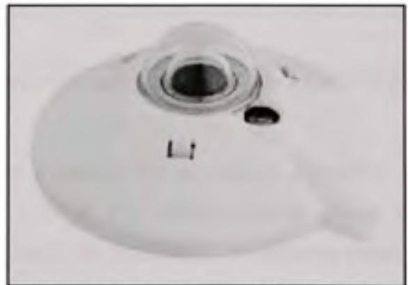
**Figure 3.2 Pyranomètre Kipp & Zonen
