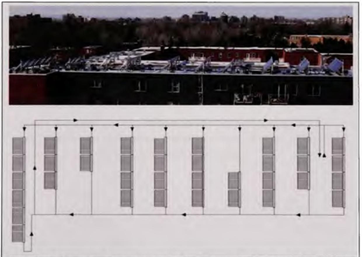
**Figure 1.4** Illustration de la configuration des panneaux solaires sur le toit de ZOO.
