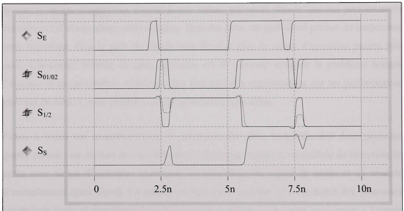
Figure 4.6 Simulation SPICE du masquage des aléas temporels à temps d'opération minimum.
