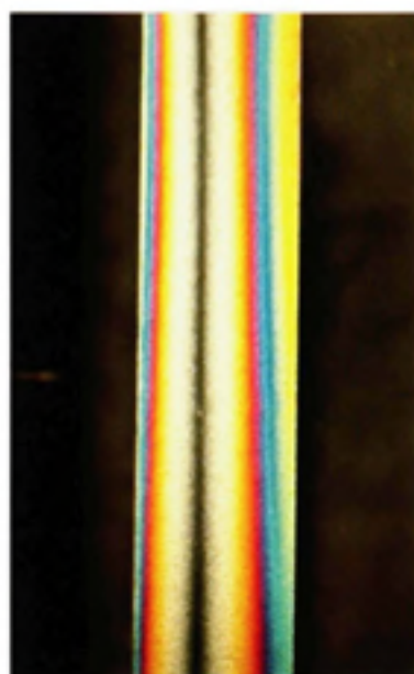
Figure 86 Essai 2 à 3.81 mm de déflexion
