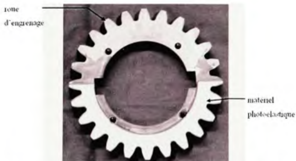
Figure 16 Roue d'engrenage avec matériel photoélastique PSM-1
