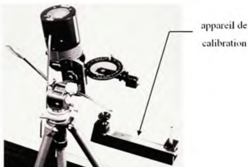
Figure 40 Montage de l'appareil de calibration pour la photoélasticité
