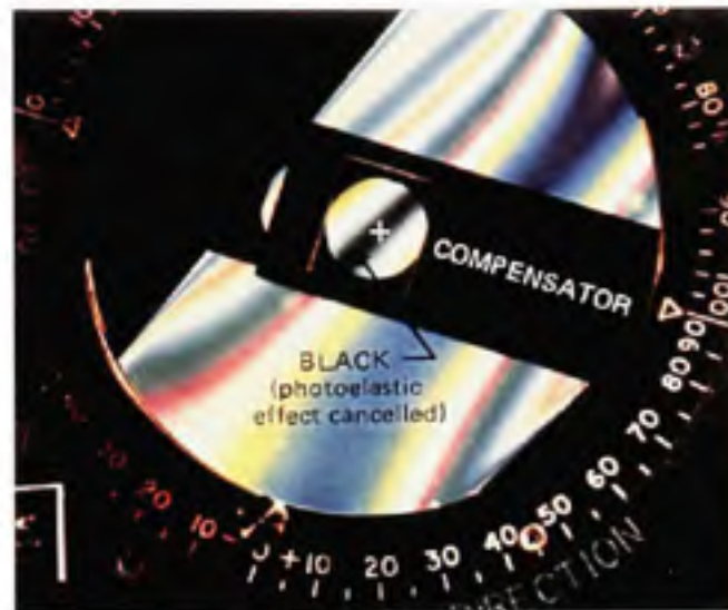
Figure 75 Manipulation du polariscope avec le compensateur (Adapté de Photolastic Division measurement group, Inc., 1992)
