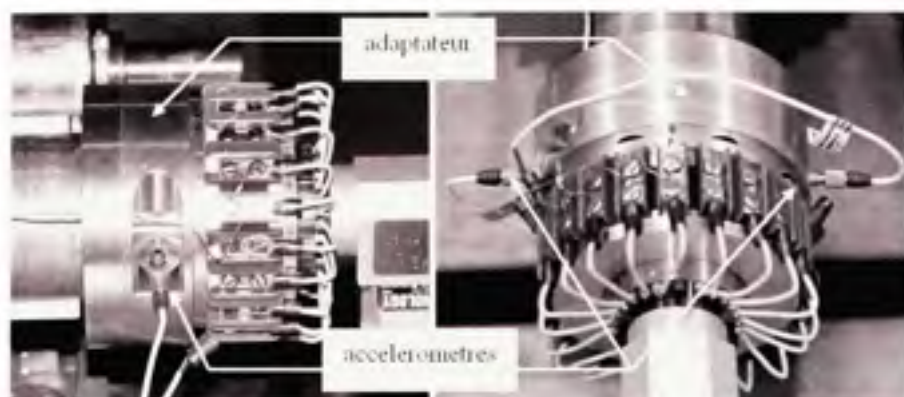
Figure 15 Adaptateur pour les accéléromètres
