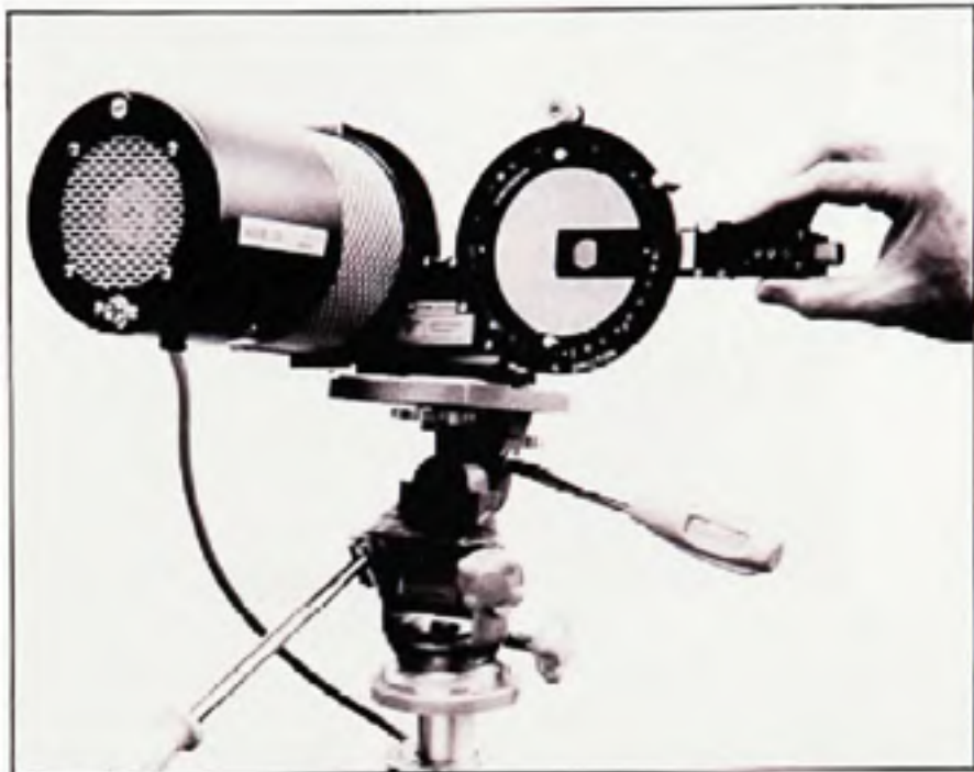
Figure 74 Positionnement du compensateur sur le polariscope (Adapté de Photolastic Division measurement group, Inc., 1992)
