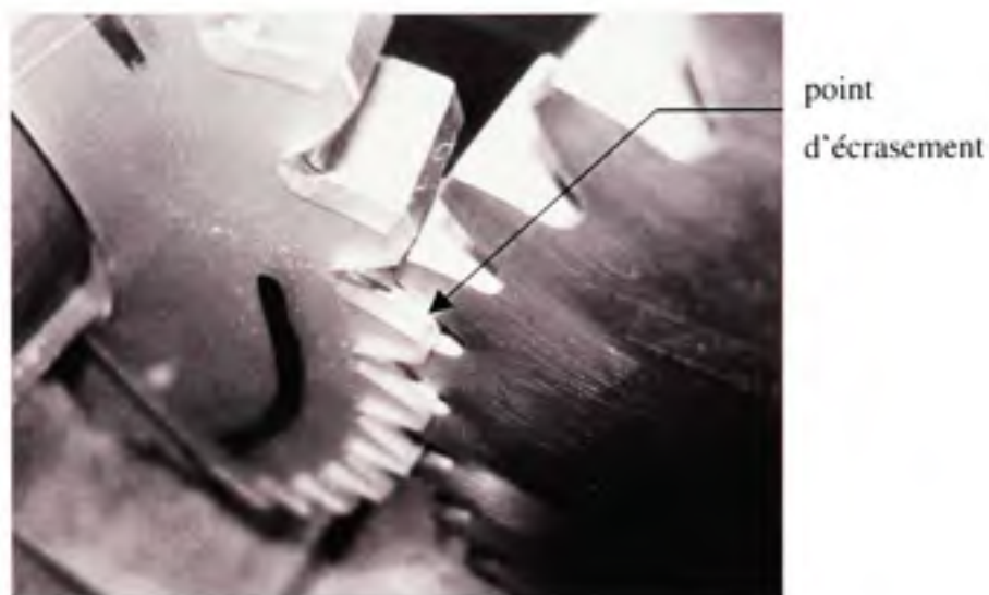
Figure 56 Point d'écrasement du matériel photoélastique
