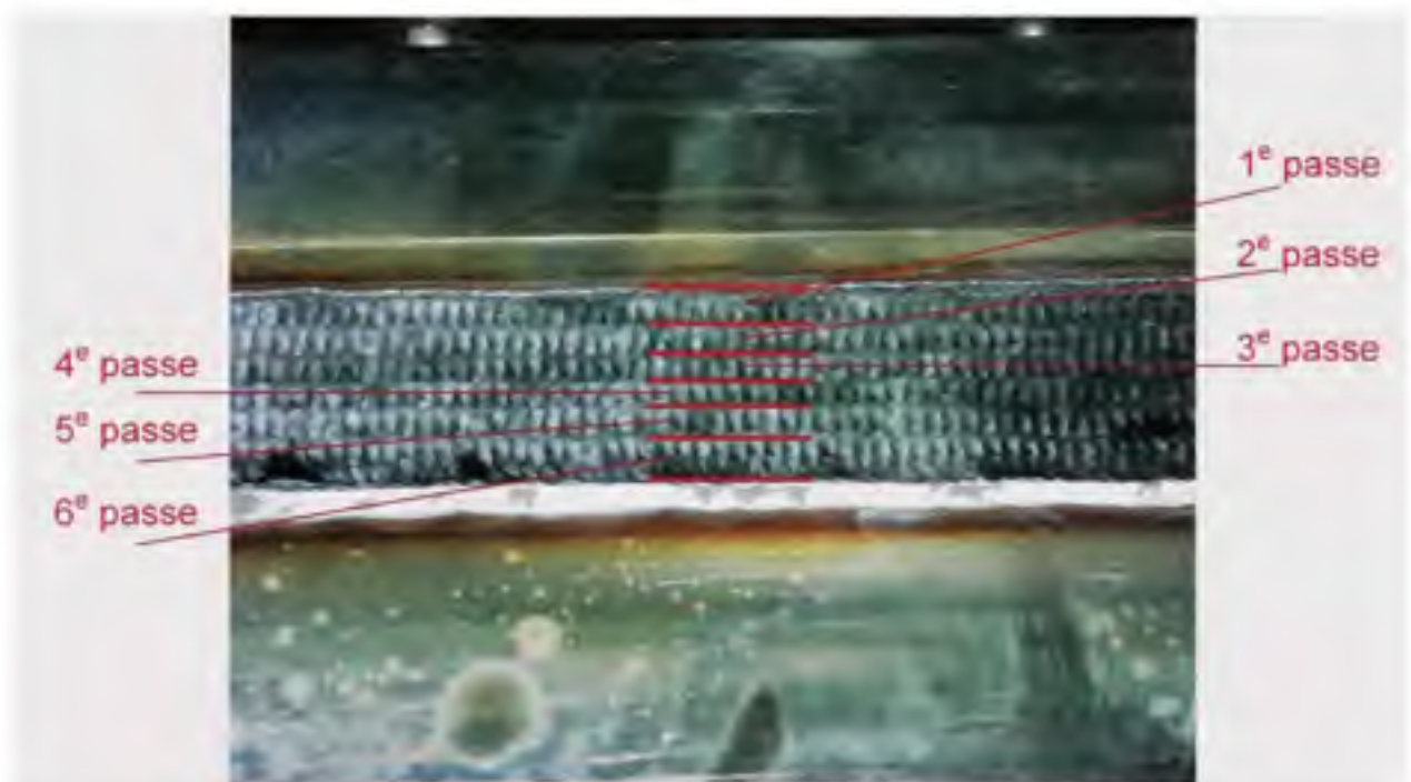
Figure 1.8 Une couche de martelage composée de 6 passes de martelage.
