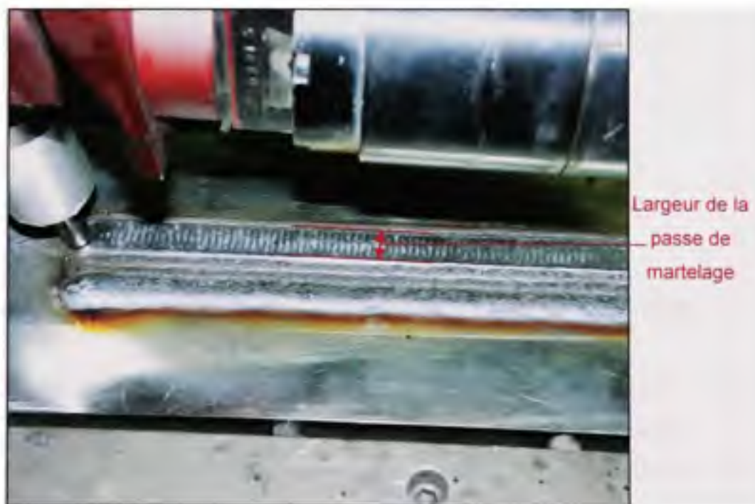
Figure 1.7 Une passe de martelage (la largeur est approximativement 2 fois le diamètre de l'empreinte laissée par un impact unitaire).
