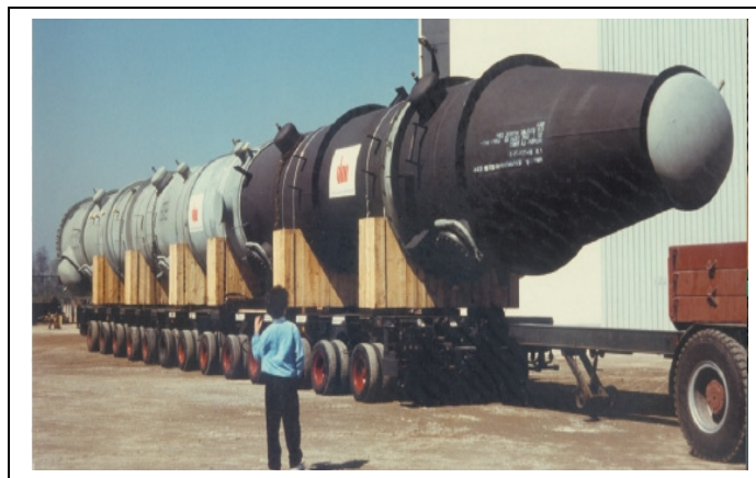
Figure 1.2 Exemple d'un générateur de vapeur. (Tirée de www.kochheattransfer.com )
