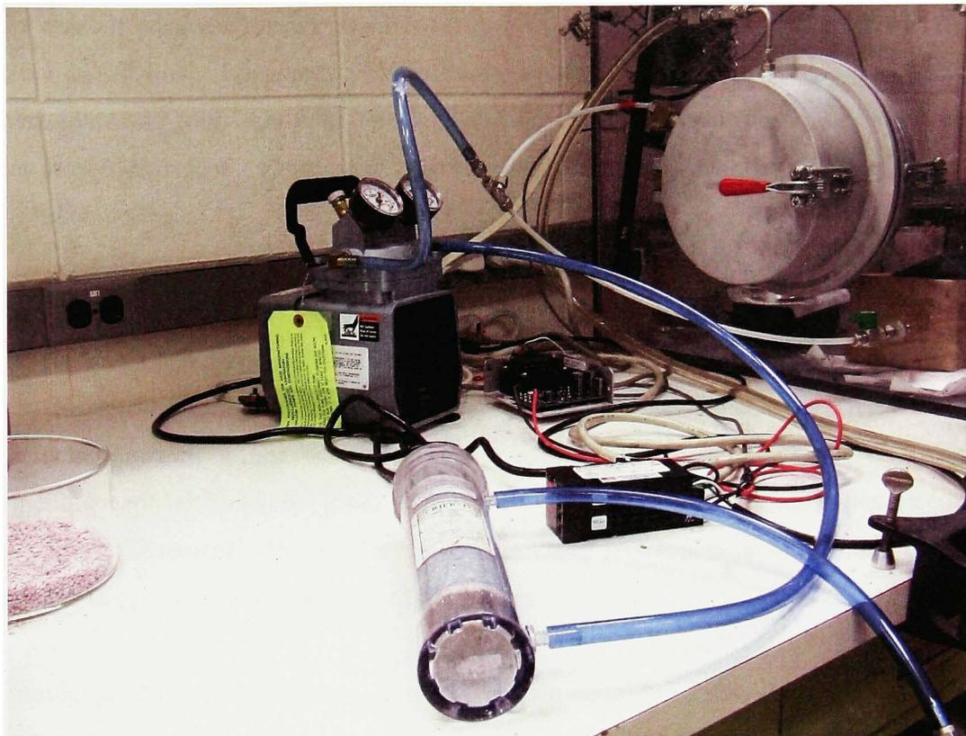
**Figure 6.3** *Système de contrôle de l'humidité de la boîte à gants.*
