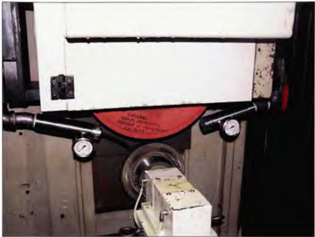
Figure 4.6 Tête de la machine-outil Mägerle en position pour la mesure de la hauteur de meule perdue.
