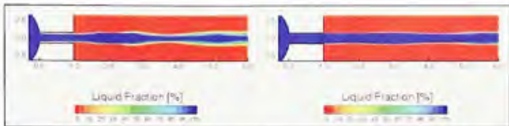
Figure 1.13 Fluctuation du jet produit par un injecteur avec modèle de cavitation (à gauche) et sans modèle (à droite).
