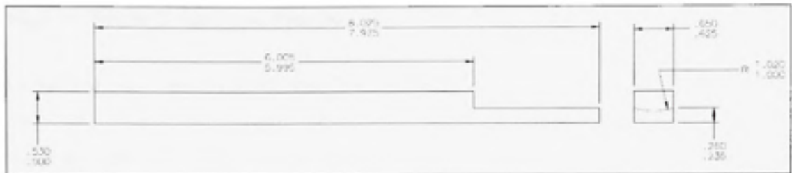
Figure 3.5 Dessin de fabrication de la barre de référence utilisée dans les essais expérimentaux.
