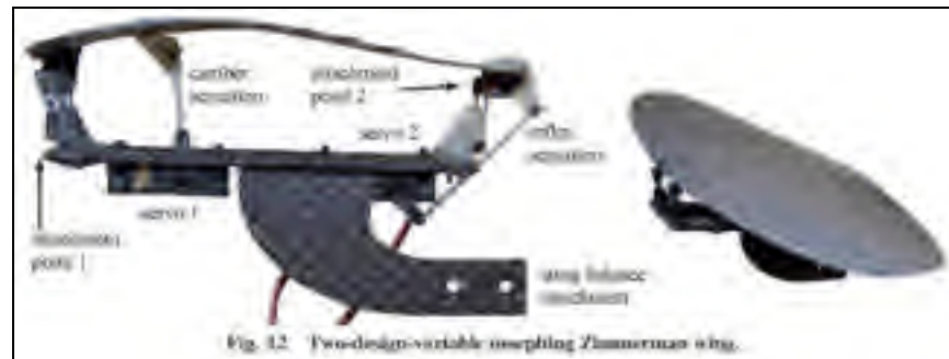
Figure 2.10 Aile adaptative d'un MAV exploitée en HIL avec deux variables de design.
