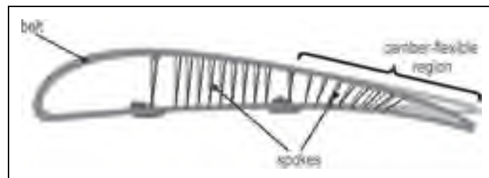
Figure 2.4 Design optimisé du belt rib concept. Tirée de Campanile and Anders (2005)
