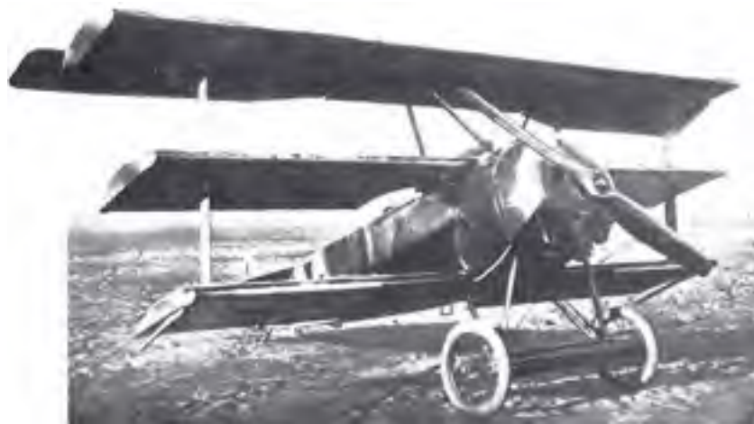
Figure 2.3 Triplan Fokker Dr-1, premier avion de guerre à utiliser un profil épais. Tirée de Mackworth-Praed (1990, p.218)
