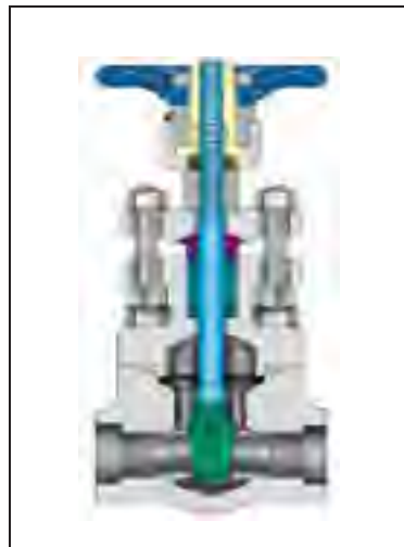
Figure 1.3 Schéma d'une valve à guillotine.
