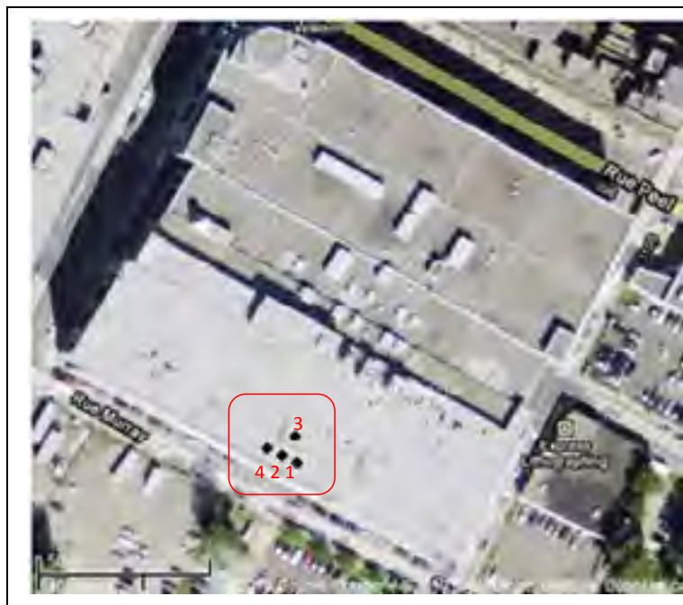
Figure 6.2 Vue satellitaire de l'emplacement des antennes GNSS sur le toit de l'ÉTS. Tirée de Google Maps (Google, 2010)
