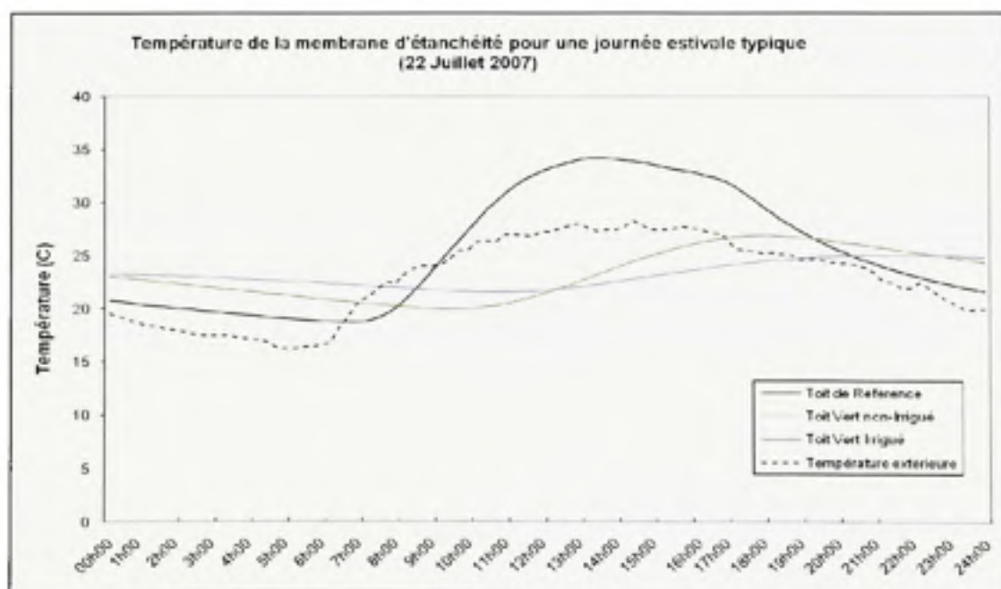
Figure 4.2 Température enregistrée au niveau de la membrane d'étanchéité pour une journée estivale typique.
