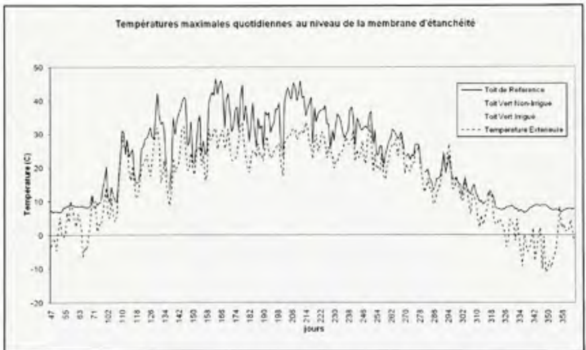
Figure 4.3 Températures maximales quotidiennes au niveau de la membrane d'étanchéité.
