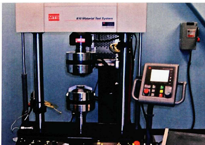
Figure 2.11 Machine MTS utilisée pour effectuer les tests mécaniques à l'école de technologie supérieure de Montréal.
