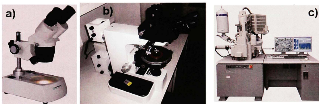
Figure 2.13 Exemples de (a) binoculaire, (b) microscope optique et (c) microscope électronique à balayage utilisés pour les analyses métallurgiques et fractographiques.
