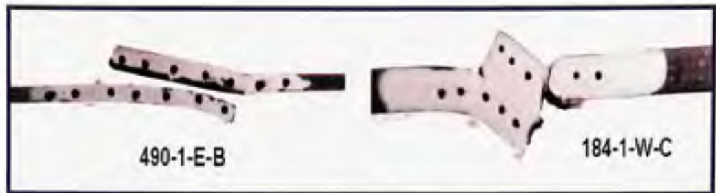
Figure 2.12 Photographies de joints brasés après les tests de traction, on peut voir les points qui auraient dû permettre de suivre l'évolution de l'angle de pivotement au cours de l'essai de traction.
