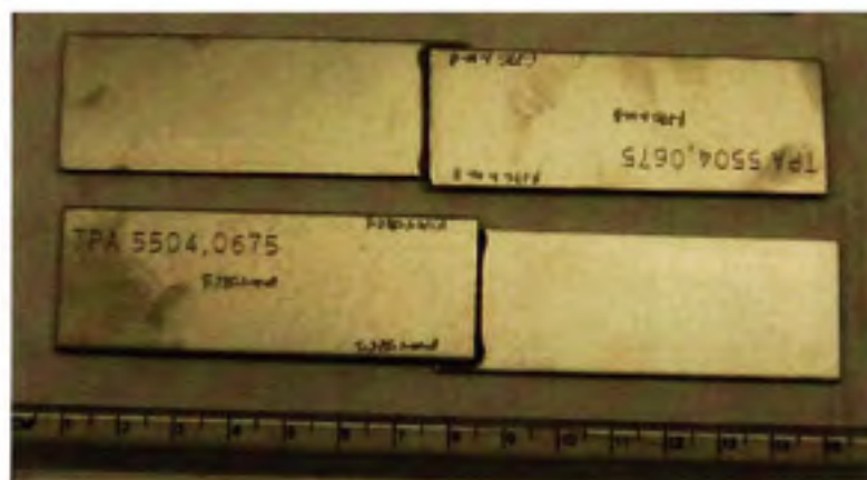
Figure 2.8 Exemples d'échantillons tels que brasés à la sortie de la fournaise.
