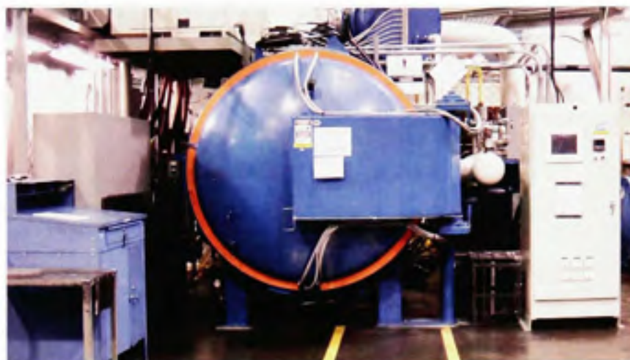
Figure 2.7 Fournaise sous vide utilisée pour le brasage des échantillons.
