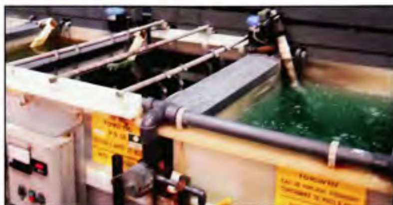
Figure 2.4 Bains électrolytiques utilisés pour la préparation de surface des matériaux utilisés.
