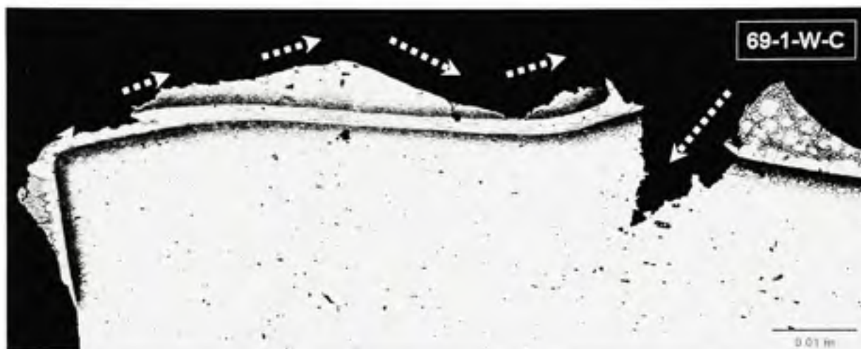
Figure 3.34 Profil de propagation des fissures dans les joints courts sans eutectiques, exemple d'un joint de 1.75 mm (0.069 pouce) de recouvrement.
