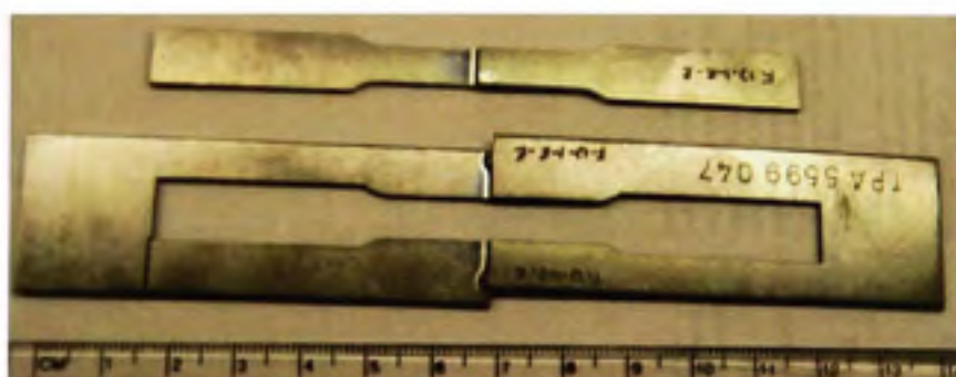
Figure 2.10 Éprouvette type de joint brasé utilisée pour les tests mécaniques (ASTM E 08-4).
