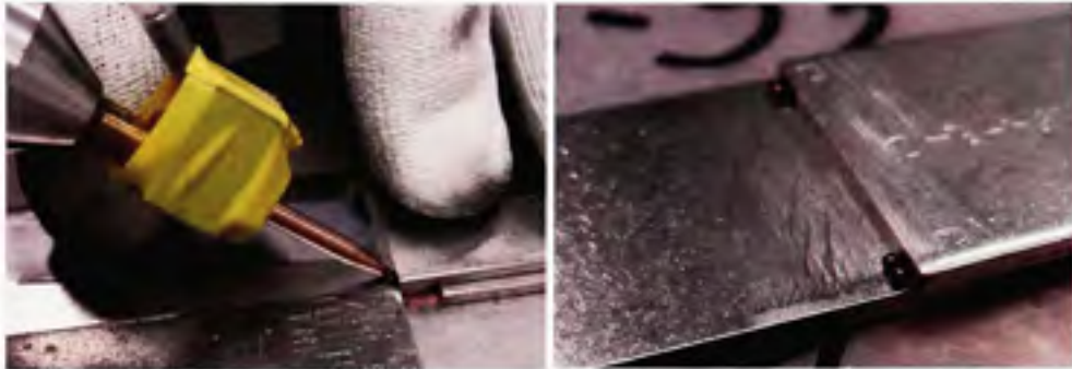
Figure 2.5 Pré-assemblage de deux plaquettes avant introduction de la pâte à braser sur une extrémité du joint.
