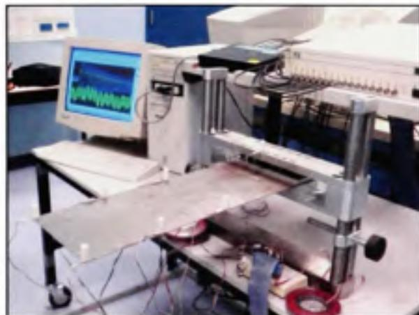
Figure 2.12 Essai d'une plaque encastrée dans l'air.
