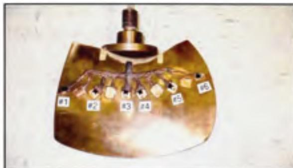
Figure 2.25 Disposition des capteurs de pression sur l'aube.
