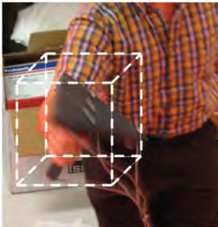
Figure 3.2 Mouvement de balayage à l'intérieur d'une division du volume d'étalonnage.
