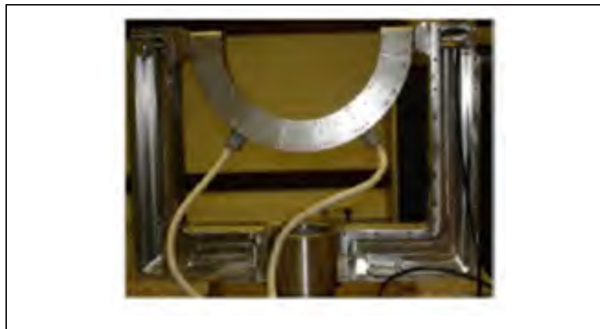
Figure 8.1 Prototype d'une sonde échographique semi-circulaire proposé par Rouyer, Mensah et Lasaygues (2010)
