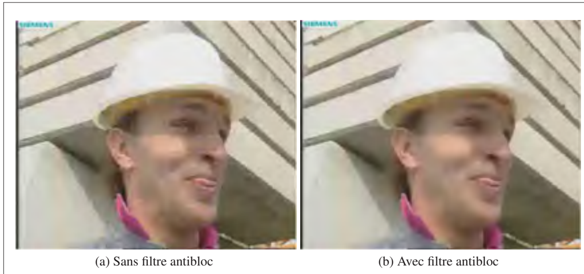
Figure 1.12 Exemple de l'application du filtre antibloc sur une trame fortement compressée. Adaptée de Schäfer et al. (2003, p. 7)
