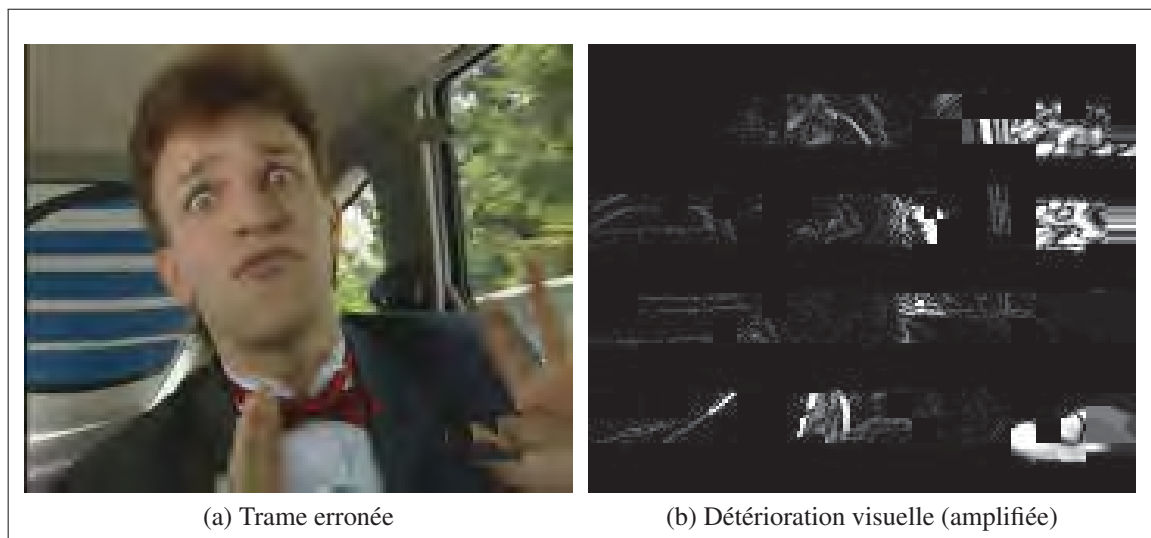
Figure 2.6 Exemple de la détérioration visuelle issue du décodage d'une tranche corrompue contenue dans une trame avec un ordonnancement de type entrelacé.
