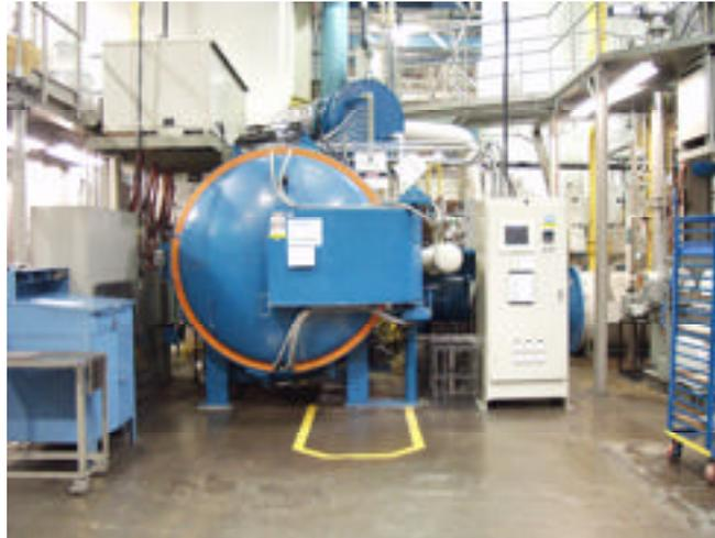
Figure 2.7 Un des fours horizontaux de brasage sous vide de Pratt & Whitney Canada (Turner, 2005)
