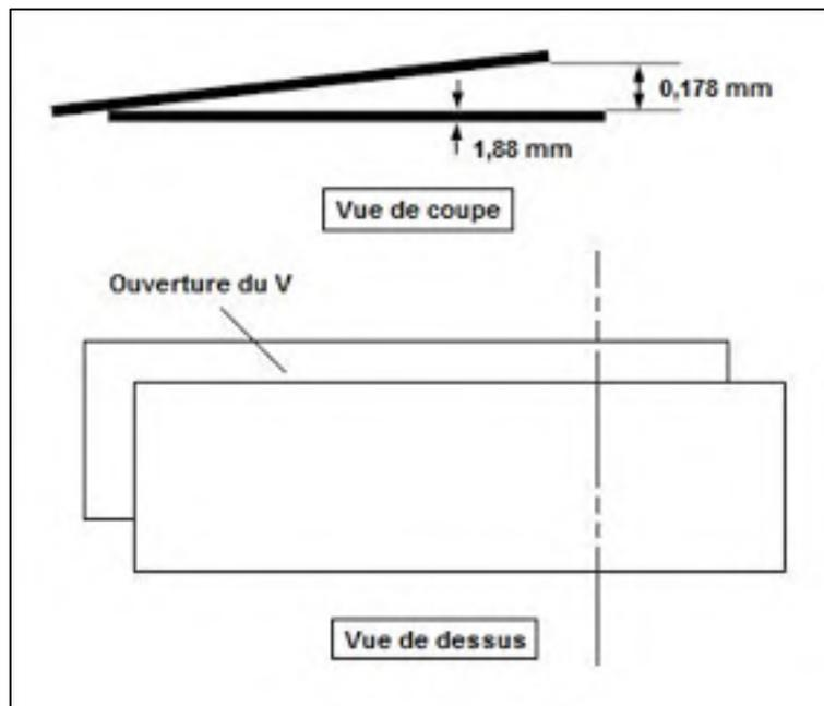
Figure 2.2 Montage en V des essais de brasage
