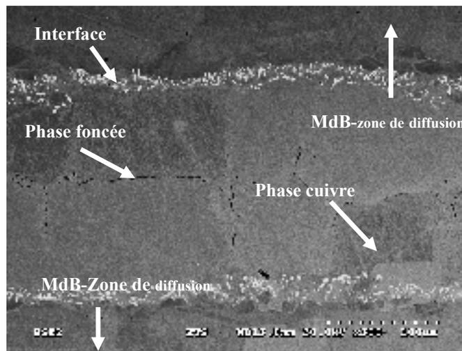
Figure 3.32 Image MEB en mode BSE montrant les différentes caractéristiques d'un joint de BCu-1 brasé 150 minutes
