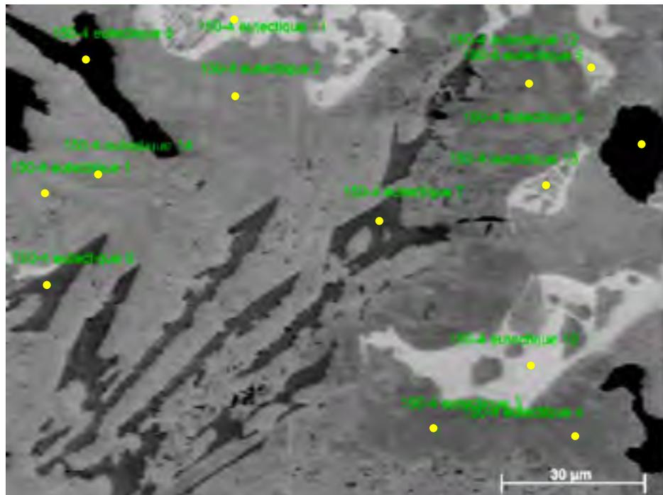
Figure-A VIII-2 Image FEG des pointés d'analyses chimiques de la zone multiphasée d'un joint de BNi-1a brasé 150 minutes
