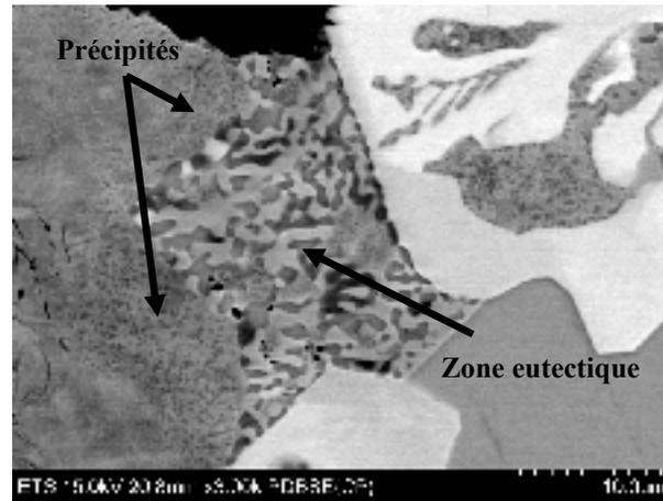
Figure 3.24 Image FEG en mode BSE de la précipitation dans la phase  $\gamma$ -nickel d'un joint de BNi-1a brasé 150 minutes
