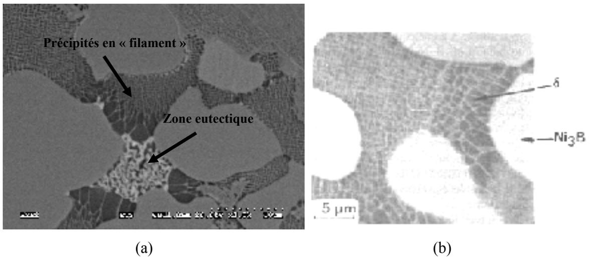
Figure 3.25 (a) Image MEB en mode BSE de la précipitation sous forme de filaments dans la phase  $\gamma$ -nickel du BNi-3 brasé 15 minutes et (b) Image MEB d'une précipitation similaire dans une phase nommée  $\delta$  (Lebaili et Hamar-Thibault, 1987)
