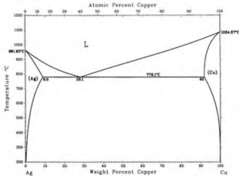
Figure 1.21 Diagramme de phases Ag-Cu
