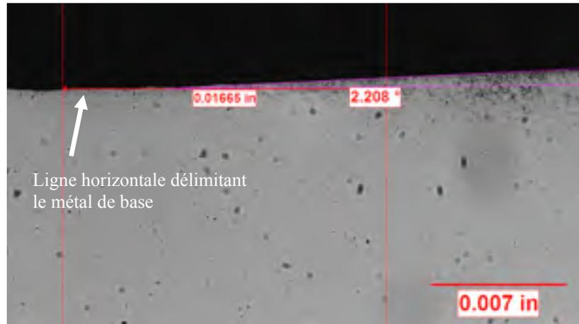
Figure 3.4 Image d'un angle de mouillage peu visible qui nécessite l'usage d'artifices pour la mesure (BAu-6)
