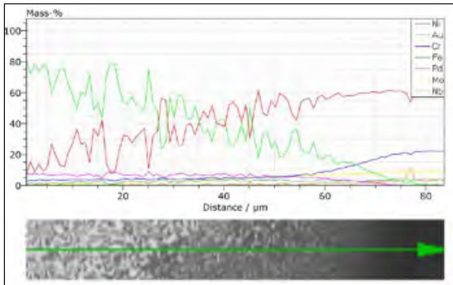
Figure 3.30 Profil de composition FEG montrant la dissolution du métal de base dans un joint de BAu-6 brasé 150 minutes
