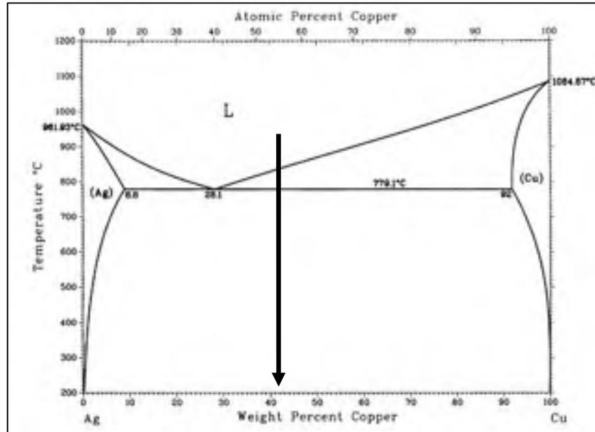
Figure 3.42 Diagramme de phases Ag-Cu indiquant la composition de l'alliage de brasage BAg-13a, un alliage hypereutectique (Subramanian et Perezko)
