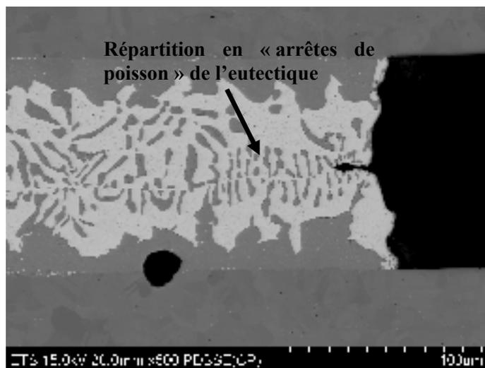
Figure 3.43 Image FEG d'un joint de BAg-13a brasé 150 minutes montrant la disposition particulière de l'eutectique dans certains endroits
