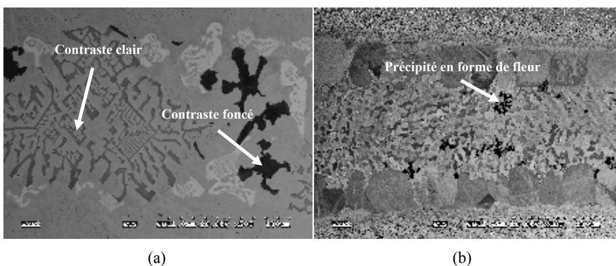
Figure 3.21 Images MEB en BSE de précipités situés aux grands écartements dans les alliages (a) BNi-1a (grossissement x500) et (b) BNi-2 (grossissement x180), tous deux brasés 150 minutes
