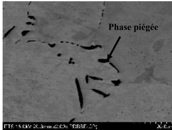
Figure 3.36 Image FEG en mode BSE du centre d'un joint de BCu-1 brasé 15 minutes montrant un composé plus foncé au milieu de la solution solide de cuivre
