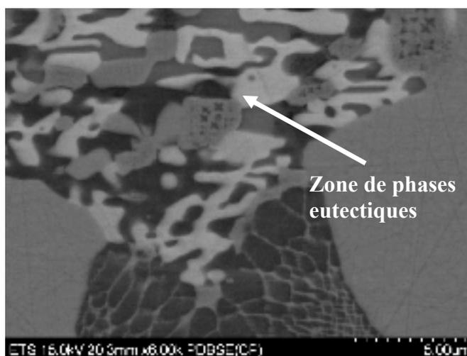
Figure 3.20 Image FEG en BSE d'une phase eutectique appartenant au joint BNi-3 brasé 150 minutes montrant la faible dimension des zones eutectiques
