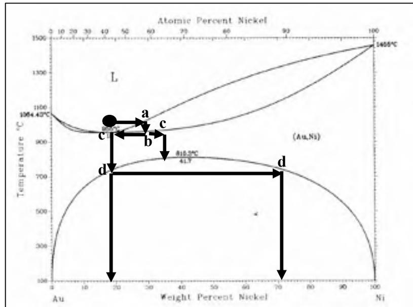
Figure 4.4 Diagramme de phases binaire Au-Ni avec le chemin parcouru lors du brasage d'un alliage BAu-4 par la phase riche en or (Okamoto et Massalski, 1991)
