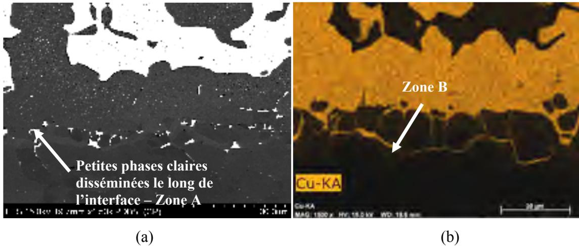
Figure 3.40 Image FEG en mode BSE et cartographie FEG de l'interface d'un joint de BAg-13a brasé 150 minutes
