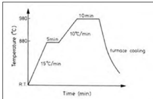
Figure 1.8 Un exemple de cycle thermique classique (Yeh et Chuang, 1997)
