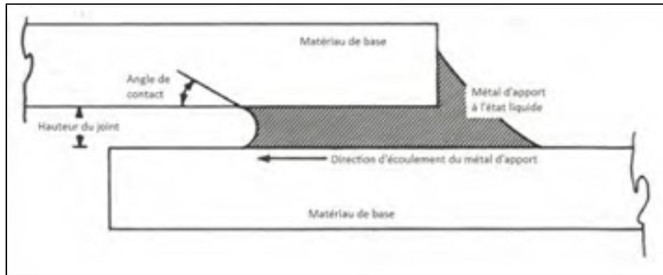
Figure 1.1 Joint brasé à recouvrement
