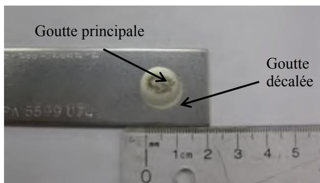
Figure 3.2 Brasure BAu-4 présentant, après brasage, la formation de deux gouttes décalées
