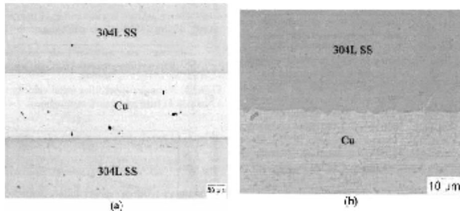
Figure 1.19 Images au MEB d'un joint brasé avec la pâte BCu-1 sur du 304 SS:
