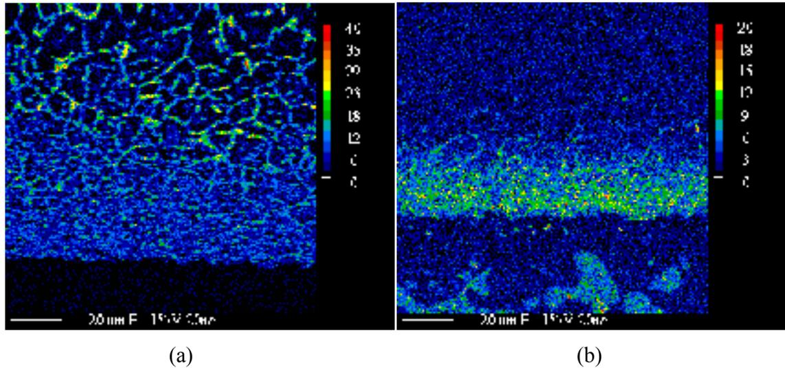
Figure 3.15 Cartographies EPMA du bore dans des joints brasés (a) BNi-2 pendant 150 minutes et (b) Palnico 36M pendant 15 minutes montrant que la zone A marque la fin de la diffusion du bore dans le métal de base
