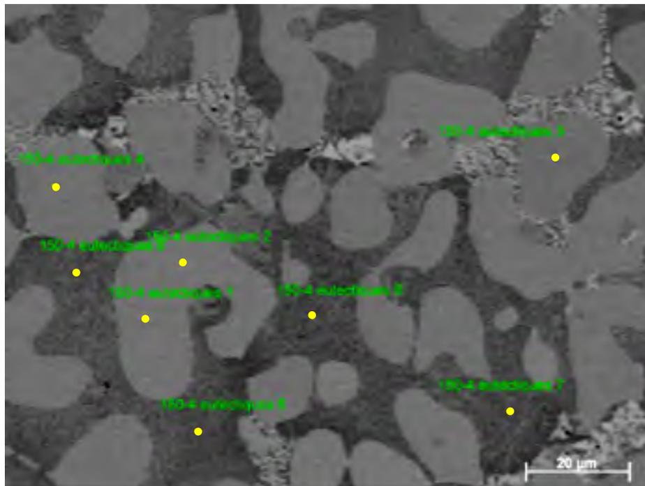
Figure-A VII-2 Image FEG des pointés des analyses chimiques de la zone multiphasée d'un joint de BNi-3 brasé 150 minutes
