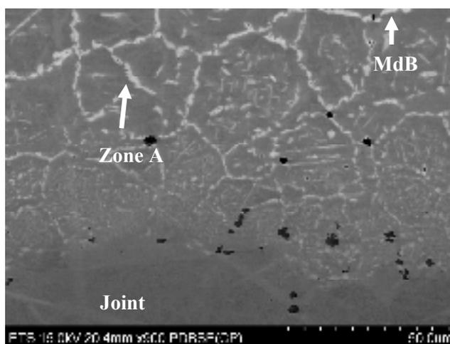
Figure 3.13 Image FEG en BSE de la zone de précipitation A possédant un contraste clair à l'interface d'un joint BNi-1a brasé 150 minutes
