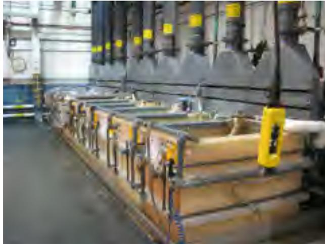
Figure 2.3 Bains contenant les solutions de nettoyage chimique
