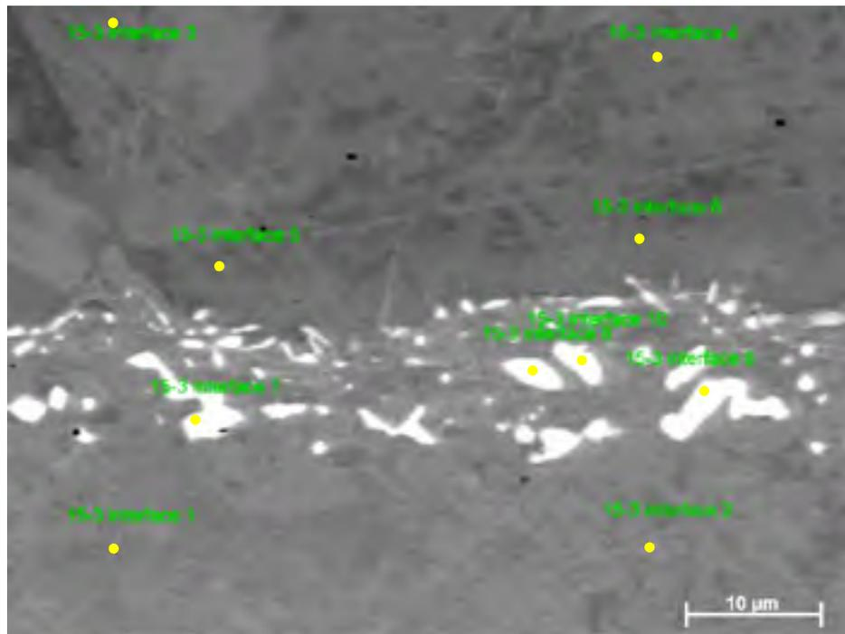
Figure-A XIII-1 Image FEG des pointés d'analyses chimiques de la zone d'interface et de diffusion d'un joint de BCU-1 brasé 15 minutes
