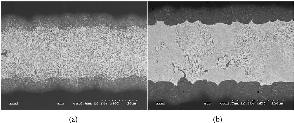
Figure 3.27 Images MEB en mode BSE de l'ensemble de deux joints brasés
