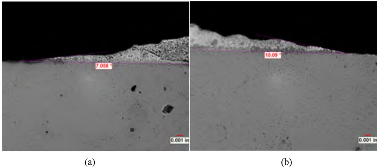
Figure 3.6 Différence importante entre l'angle de mouillage à gauche (a) et celui à droite (b) (BAg-13a)
