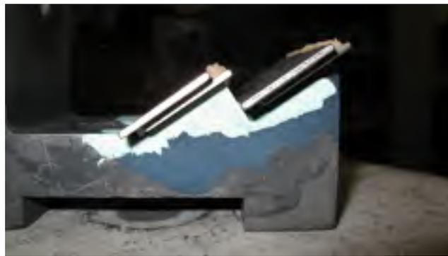
Figure 2.6 Échantillons assemblés et prêts à braser sur un support en graphite
