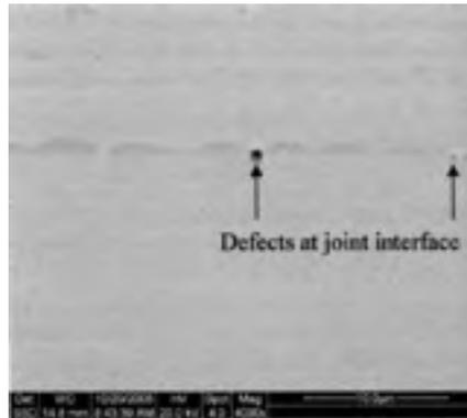
Figure 1.20 Image au MEB de l'interface cuivre/304 SS :
