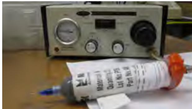
Figure 2.5 Régulateur pneumatique relié à une seringue permettant de déposer la pâte
