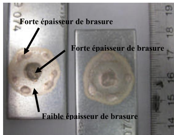
Figure 3.5 Étalement important et irrégulier du BAg-13a
