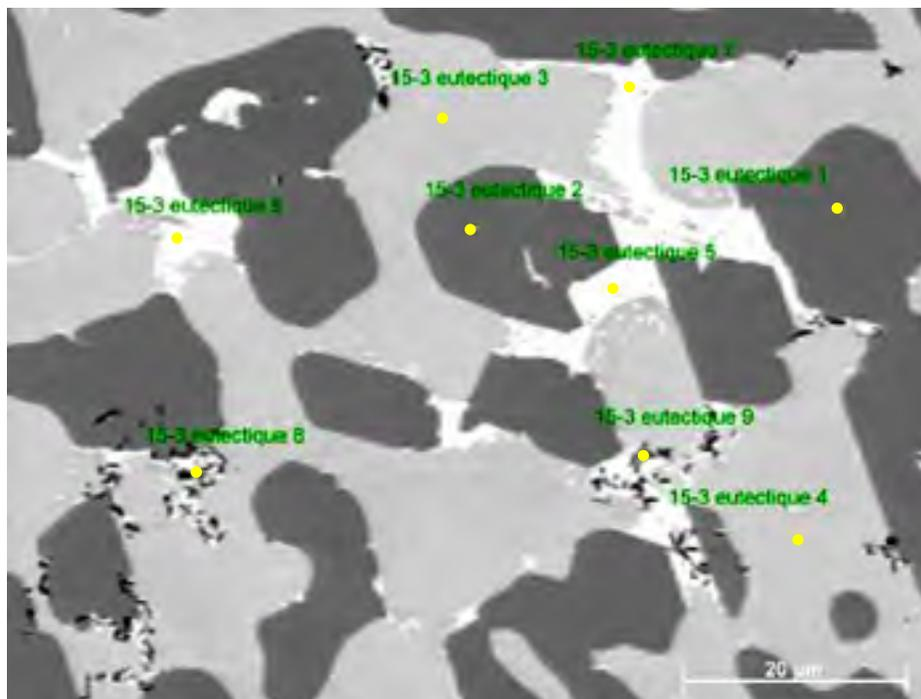
Figure-A X-2 Image FEG des pointés d'analyses chimiques de la zone multiphasée d'un joint de Palnico 36M brasé 15 minutes
