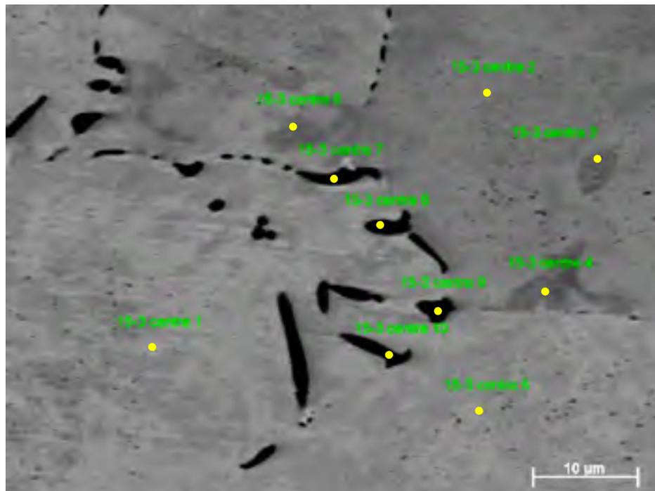
Figure-A XIII-2 Image FEG des pointés d'analyses chimiques de la zone centrale d'un joint de BCu-1 brasé 15 minutes
