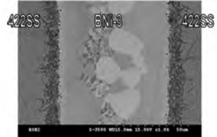
Figure 1.12 Joint brasé avec du BNi-3
