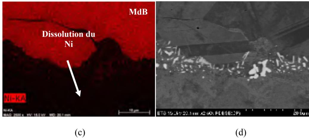
Figure 3.33 Cartes FEG montrant la dissolution importante du métal de base et la diffusion du cuivre dans le métal de base dans un joint de BCu-1 brasé 15 minutes
