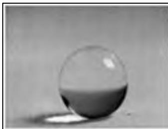
Figure 1.2 Mouillage nul d'une goutte d'eau sur du Téflon (Quéré, 2003)
