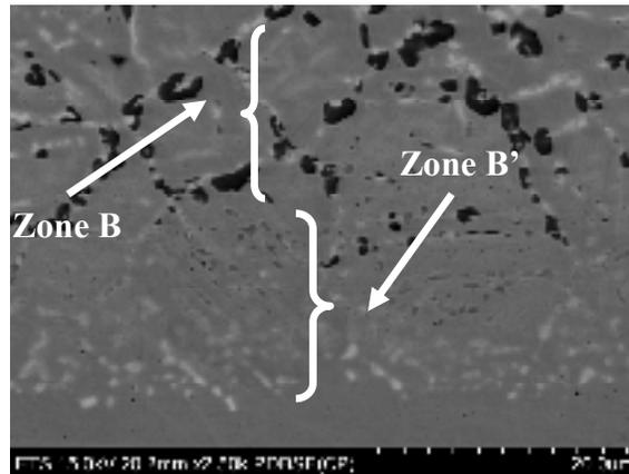
Figure 3.16 Image FEG en mode BSE des zones B et B' au niveau de l'interface d'un joint BNi-3 brasé 150 minutes
