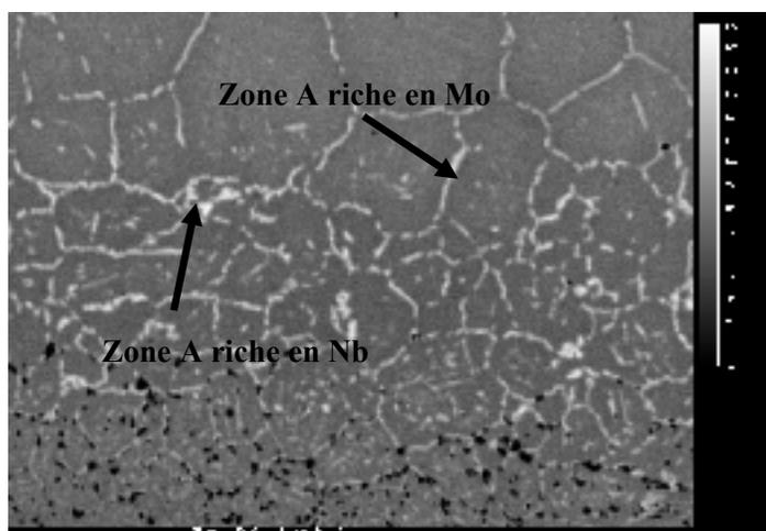
Figure 3.14 Image EPMA en mode BSE montrant les deux types différents de précipités dans la zone A à l'interface d'un joint de BNi-3 brasé 150 minutes
