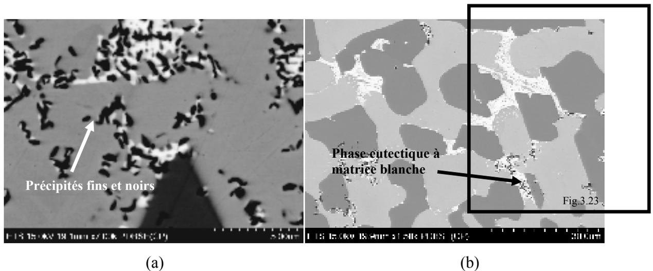
Figure 3.22 Images FEG en BSE des fins précipités (a) au niveau de la phase eutectique (b) dans l'alliage Palnico 36M brasé 15 minutes
