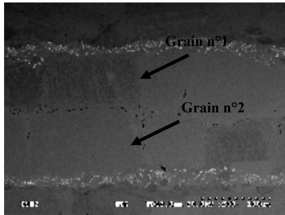
Figure 3.38 Image MEB en mode BSE montrant la taille des grains de la solution solide de cuivre d'un joint de BCu-1 brasé 15 minutes
