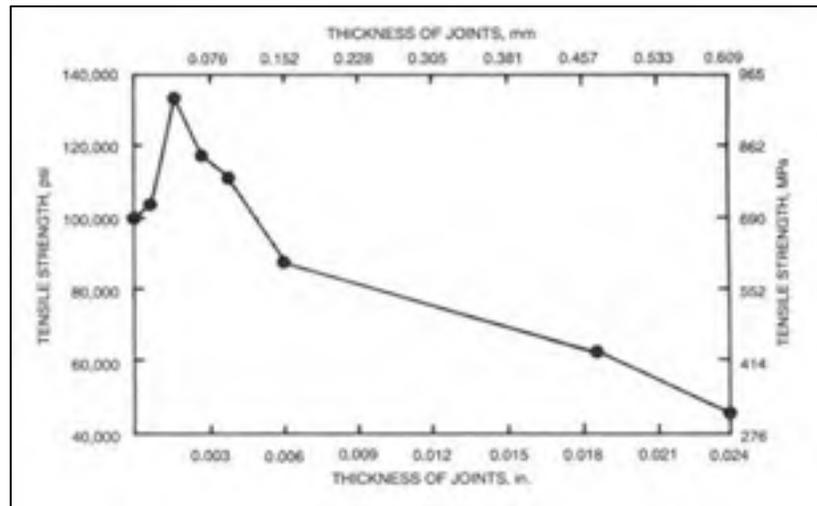
Figure 1.7 Impact de la hauteur du joint sur la résistance en traction de l'assemblage : aciers inoxydables brasés en bout à bout avec du BAg-1a (AWS, 2007)
