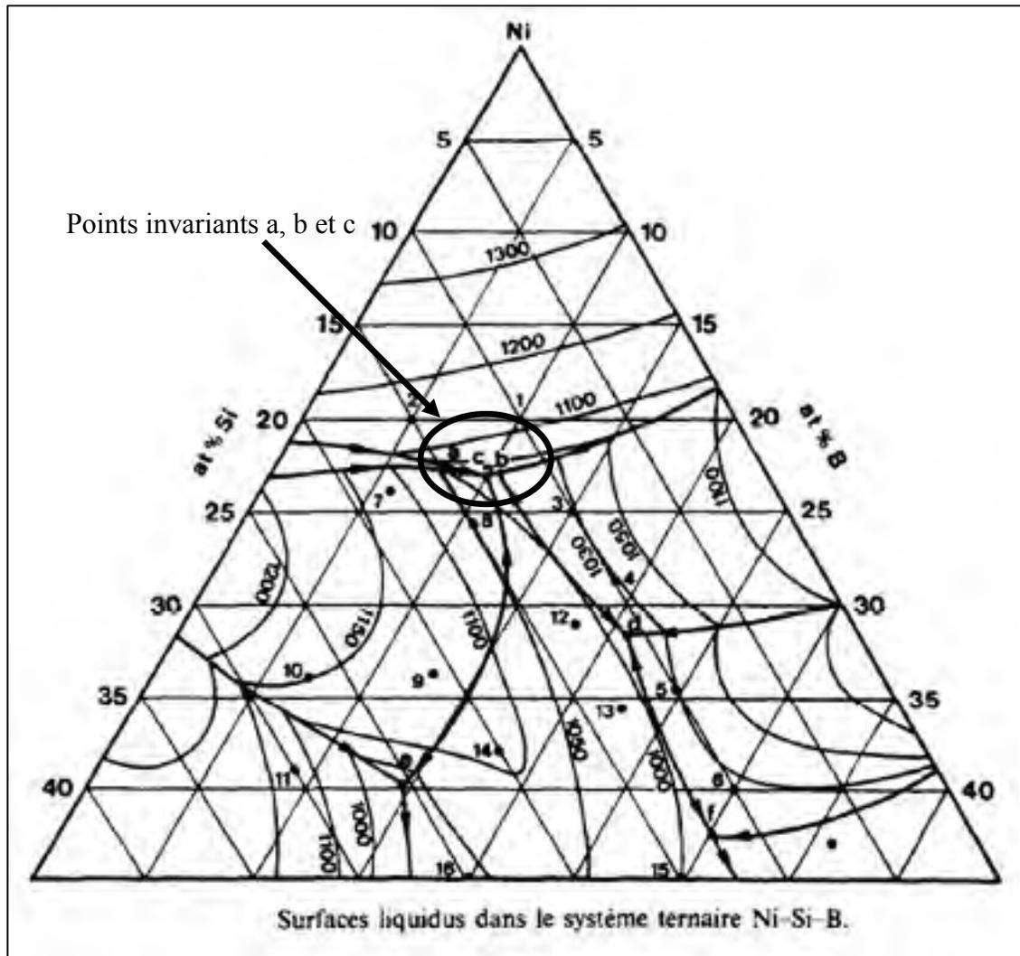
Figure 4.1 Projection du liquidus du système ternaire Ni-Si-B avec les points invariants a, b et c (Lebaili et Hamar-Thibault, 1987)
