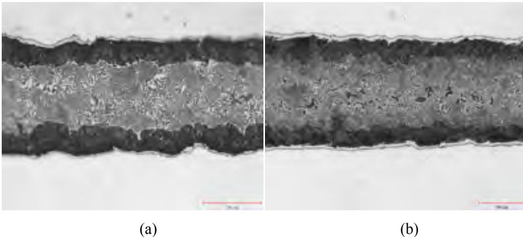
Figure 4.5 Images prises au microscope optique montrant un début de coalescence de la phase centrale dans un joint de BAu-6 brasé (a) 15 minutes (grossissement x500) et (b) 150 minutes (grossissement x 200)
