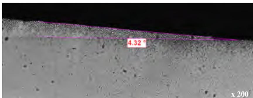
Figure 3.3 Image d'un angle de mouillage facile à observer et à mesurer (BCu-1)
