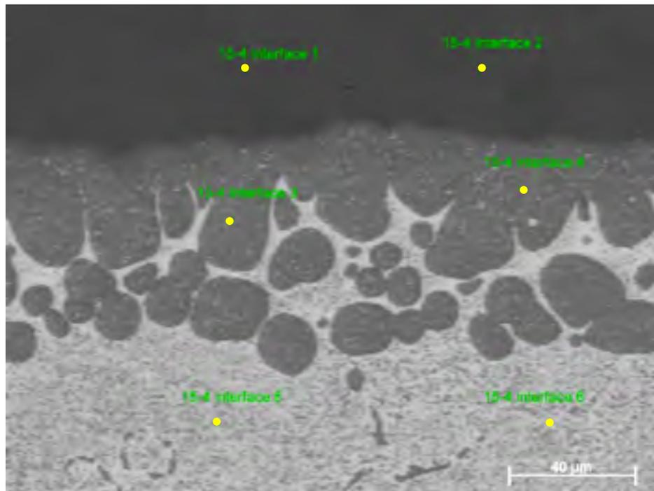
Figure-A XI-1 Image FEG des pointés d'analyses chimiques de la zone d'interface et de diffusion d'un joint de BAu-4 brasé 15 minutes
