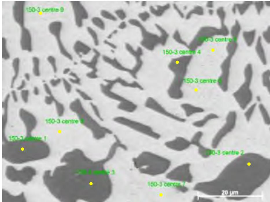
Figure-A XIV-2 Image FEG des pointés d'analyses chimiques de la zone centrale d'un joint de BAg-13a brasé 150 minutes
