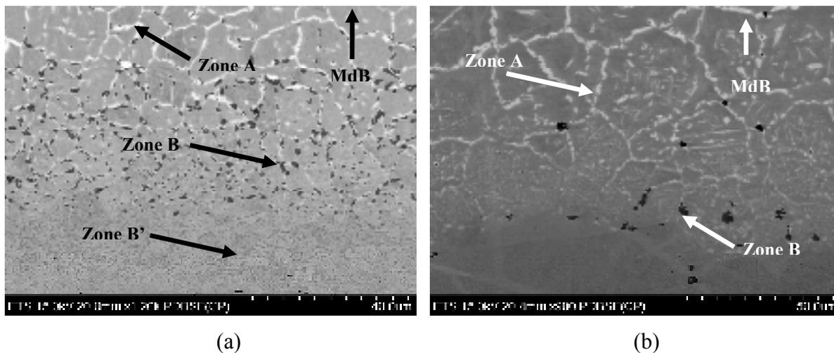
Figure 3.11 Images FEG en BSE des interfaces et zones de diffusion des alliages (a) BNi-2 et (b) BNi-1a tous deux brasés 150 minutes
