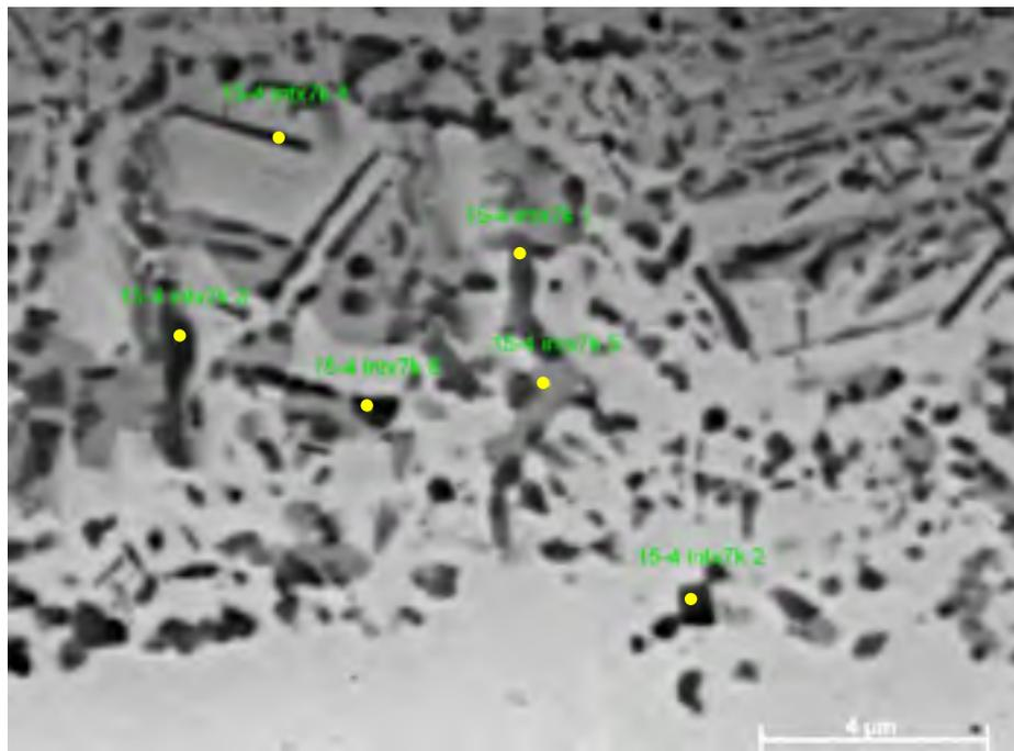
Figure-A X-1 Image FEG des pointés d'analyses chimiques de la zone d'interface et de diffusion d'un joint de Palnico 36M brasé 15 minutes
