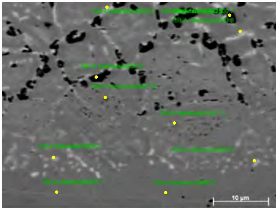
Figure-A VII-1 Image FEG des pointés d'analyses chimiques de la zone d'interface et de diffusion du BNi-3 brasé 150 minutes. Le pointé correspond au point jaune situé en dessous de l'identification du pointé
