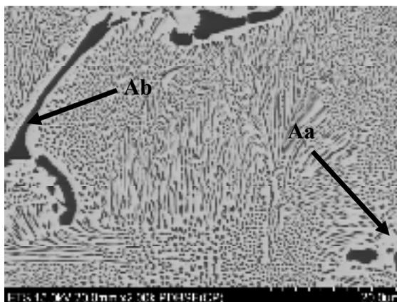
Figure 3.31 Image FEG en mode BSE de la zone centrale d'un joint brasé BAu-4 brasé 15 minutes montrant la très fine structure en lamelle du composé A
