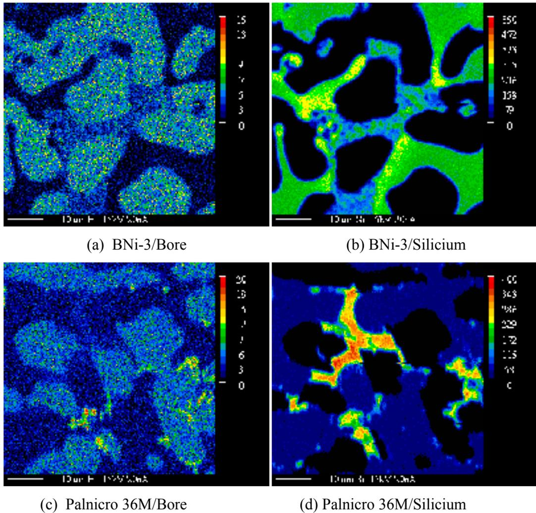
Figure 3.19 Cartographies EPMA des éléments bore et silicium pour les alliages de brasage BNi-3, brasé 150 minutes (a et b) et Palnico 36M, brasé 15 minutes (c et d) montrant la non-compatibilité entre le bore et le silicium
