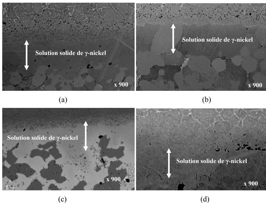
Figure 3.17 Images MEB en BSE des différentes couches de solution solide  $\gamma$ -nickel pour des joints brasés 15 minutes (a) BNi-2, (b) BNi-3, (c) Palnico 36M et (d) BNi-1a
