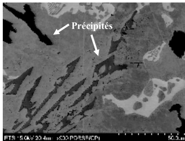
Figure 4.2 Image FEG de précipités Cr-B d'un joint de BNi-1a brasé 150 minutes
