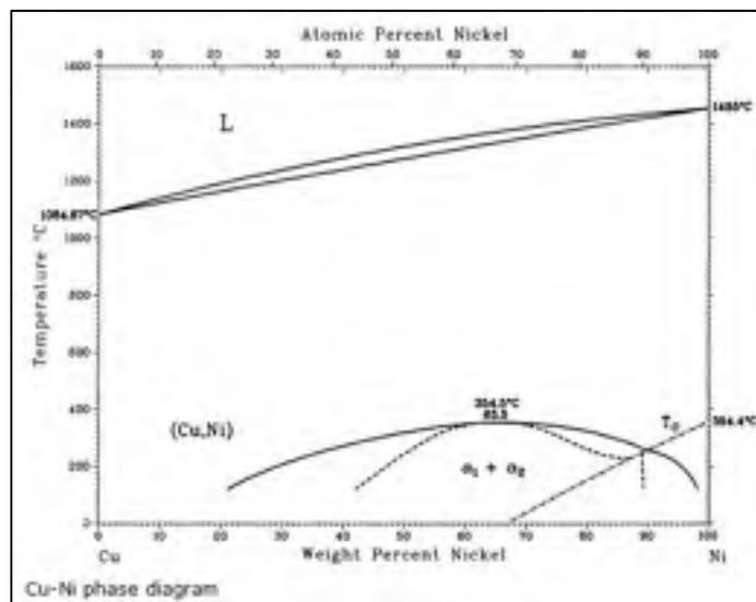
Figure 3.37 Diagramme de phases Cu-Ni montrant la miscibilité totale entre le Cu et Ni (Chakrabarti et al., 1991)
