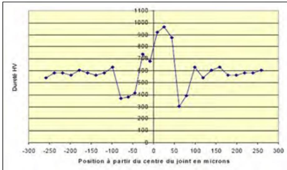
Figure 1.10 Profil de microdureté dans un joint brasé avec du BNi-2 à 1050°C pendant 10 min et ayant un écartement final d'environ 160 µm (Turner, 2005)
