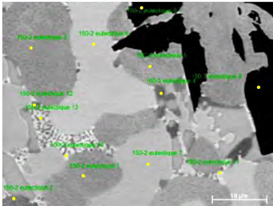
Figure-A IX-2 Image FEG des pointés d'analyses chimiques de la zone multiphasée d'un joint de BNi-2 brasé 150 minutes
