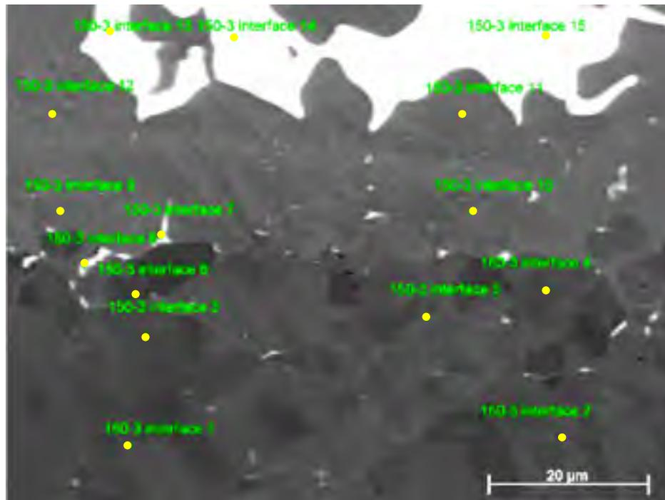
Figure-A XIV-1 Image FEG des pointés d'analyses chimiques de la zone d'interface et de diffusion d'un joint de BAG-13a brasé 150 minutes
