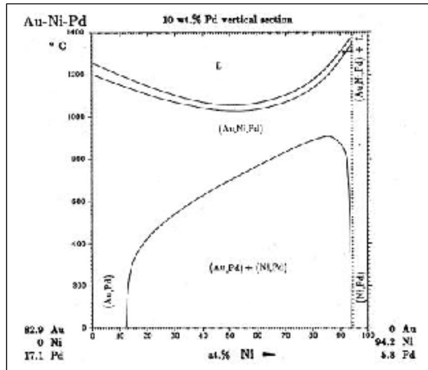
Figure 1.18 Diagramme de phase pseudobinaire Au-Ni-Pd
