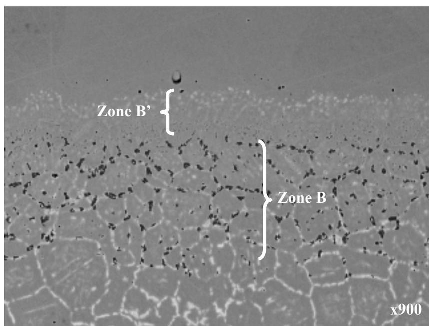
Interface B et B' d'un joint de BNi-3 brasé 150 minutes (x900)
