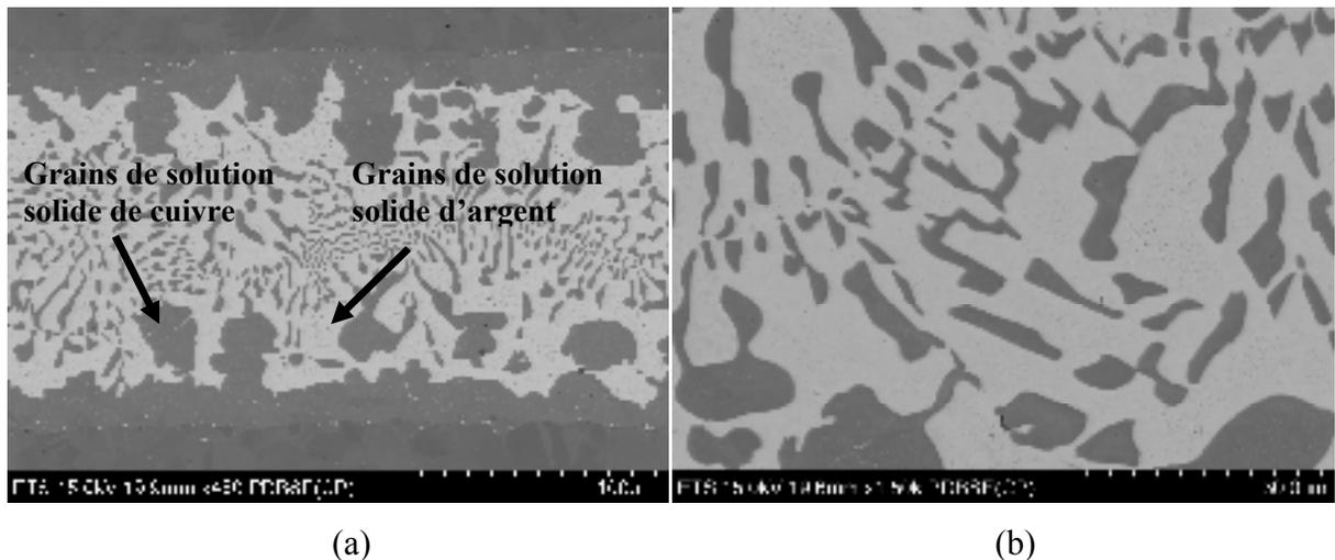
Figure 3.41 Images FEG en mode BSE montrant la microstructure hypereutectique d'un joint de BAg-13a brasé 150 minutes
