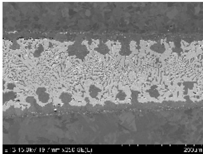
Figure 3.39 Image FEG en mode SE de l'ensemble d'un joint de BAg-13a brasé 15 minutes
