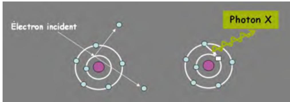
Figure 2.10 Principe de l'analyse par détecteur EDS
