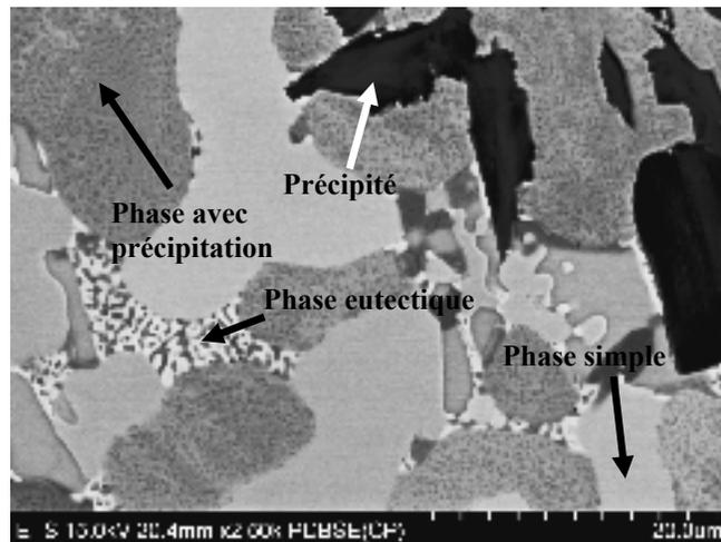
Figure 3.18 Image FEG en mode BSE de la zone multiphasée d'un joint de BNi-2 brasé 150 minutes
