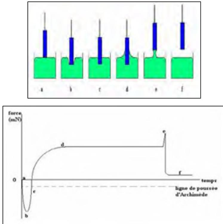
Figure 1.5 Principe d'une balance de mouillage
