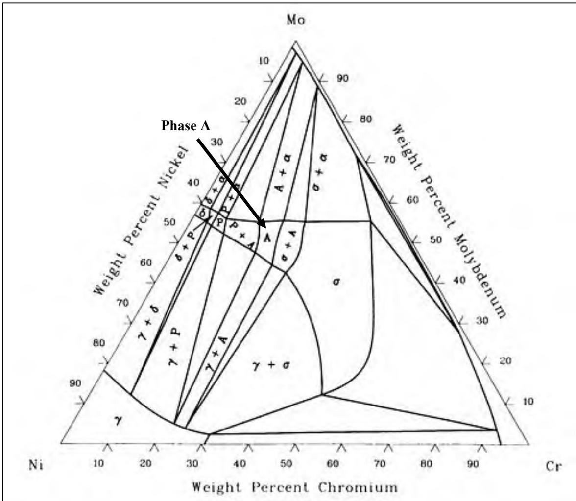
Figure 3.35 Diagramme de phase ternaire Cr-Mo-Ni dont la phase A correspond à la composition des précipités de l'interface d'un joint de BCu-1 (Gupta, 1990)
