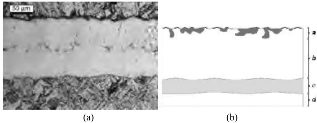
Figure 1.15 Joint brasé avec la pâte BAu-4 : a) Image au MEB et b) schéma d'un demi-joint représentant la morphologie du joint (Nowacki, Danielewski et Filipek, 2004)
