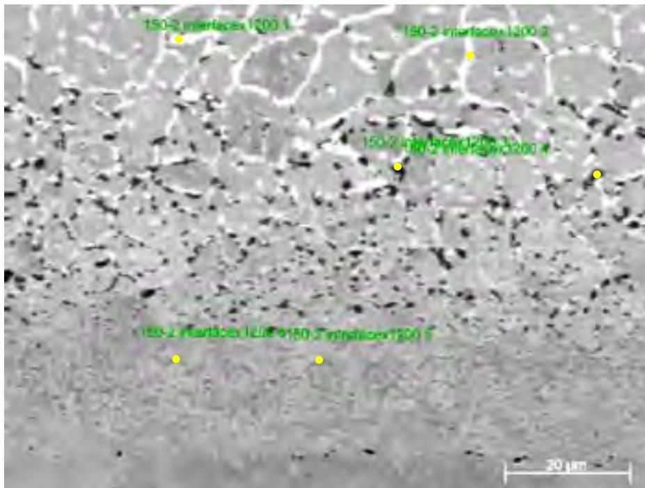
Figure-A IX-1 Image FEG des pointés d'analyses chimiques de la zone d'interface et de diffusion d'un joint de BNI-2 brasé 150 minutes
