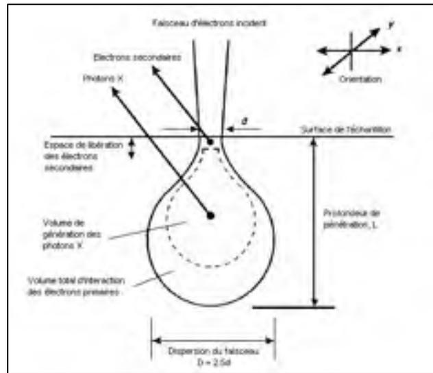
Figure 2.9 Impact du faisceau d'électrons sur l'échantillon produisant différentes émissions (adapté de Humpston et Jacobson, 1993)
