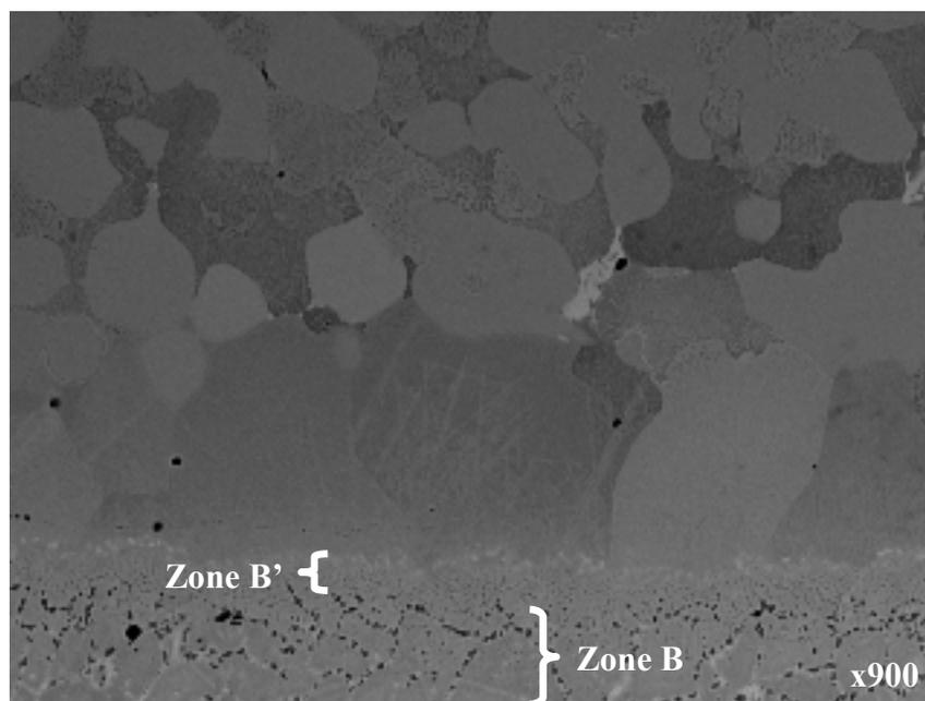
Interface B et B' d'un joint de BNi-3 brasé 15 minutes (x900)
