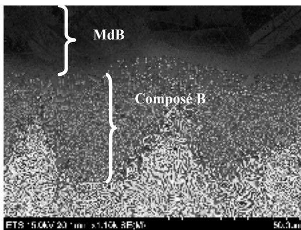
Figure 3.28 Image FEG en mode SE de la zone d'interface d'un joint de BAu-6 brasé 150 minutes montrant le composé B et ses fines lamelles et l'interface entre le métal de base et le composé B libre de tout précipité
