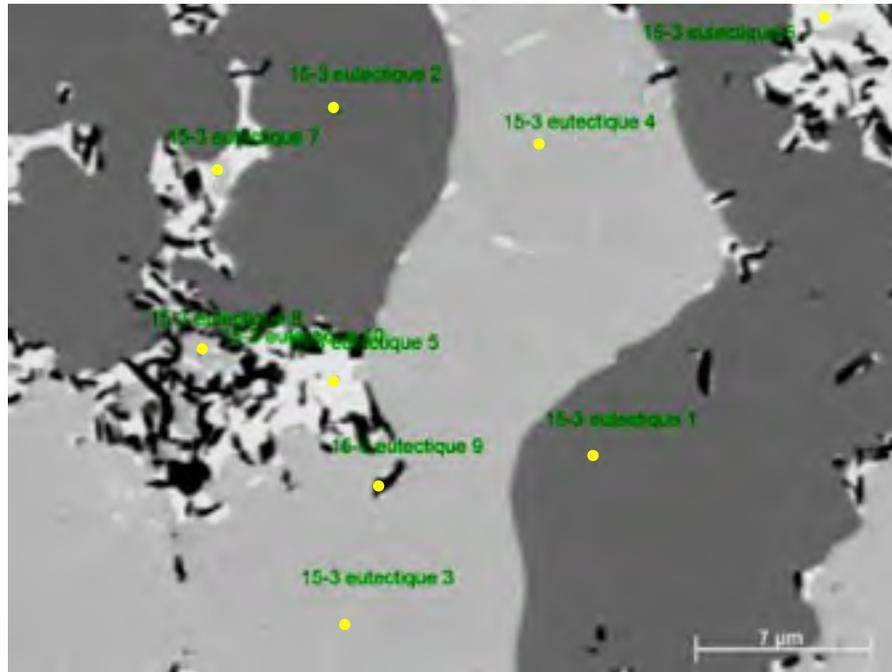
Figure-A X-3 Image FEG des pointés d'analyses chimiques de la zone eutectique d'un joint de Palnico 36M brasé 15 minutes
