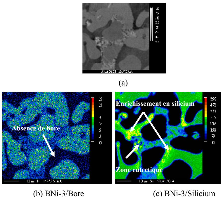
Figure 3.26 Cartographies EPMA de la zone de précipitations dans un joint de BNi-3 brasé 150 minutes montrant la concentration en silicium proche de la zone eutectique et l'absence de bore dans la zone de précipitation
