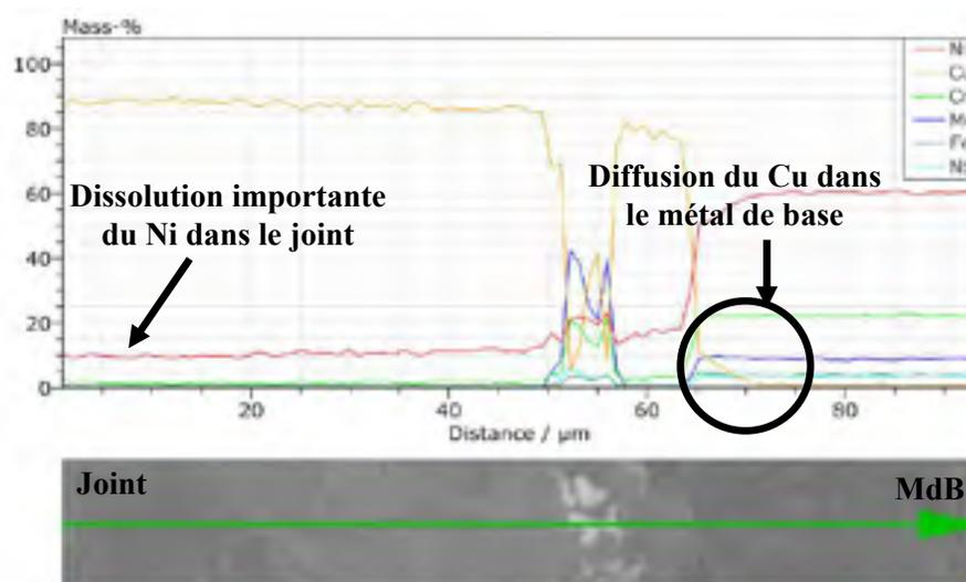
Figure 3.34 Profil de compositions FEG montrant la dissolution importante du métal de base et la diffusion du cuivre dans le métal de base dans un joint de BCu-1 brasé 15 minutes
