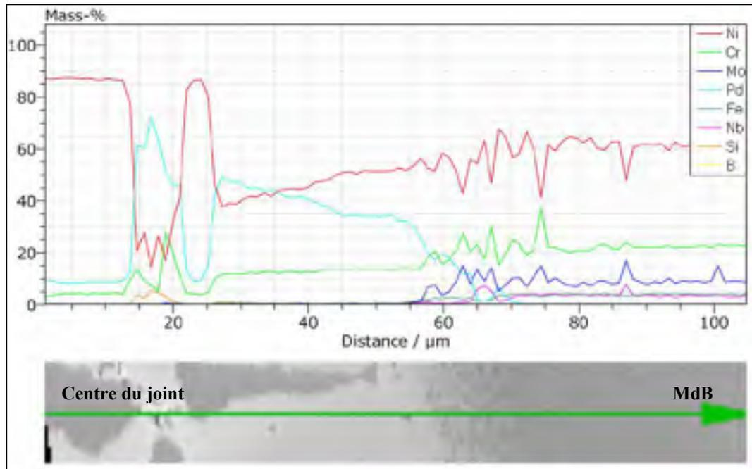
Figure 3.10 Profil de composition FEG de l'interface d'un joint Palnico 36M brasé 15 minutes sur de l'Inconel 625 montrant l'importante dissolution/diffusion entre le métal de base et le joint mise en évidence par les pentes de transition relativement douces entre les deux domaines
