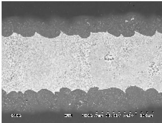
Figure 4.3 Image MEB d'un joint de BAu-4 brasé 150 minutes montrant la disposition des différentes phases dans le joint
