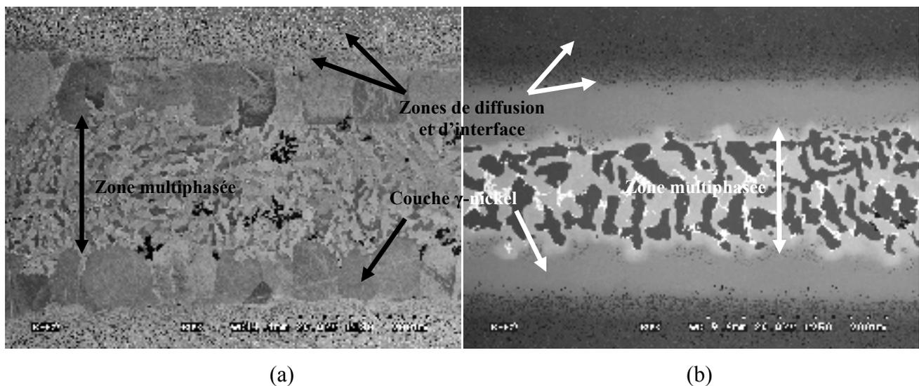
Figure 3.9 Images MEB en mode BSE décrivant les différentes composantes de joints brasés 150 minutes (a) BNi-2 et (b) Palnico 36M
