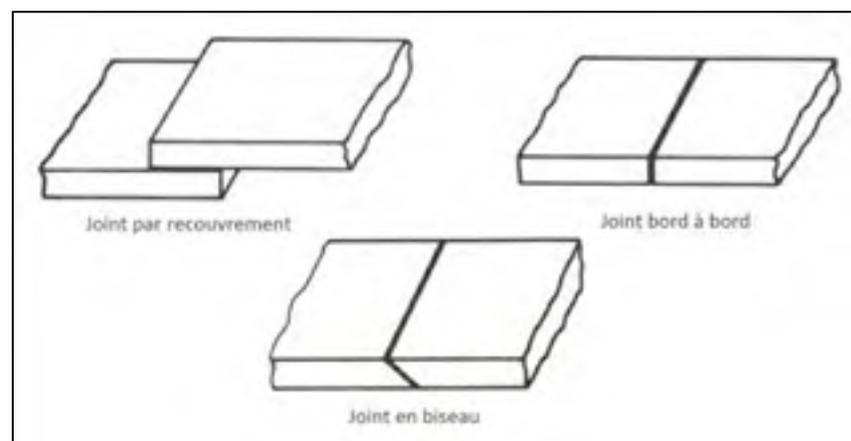
Figure 1.6 Différentes sortes de joints : par recouvrement, bord à bord et en biseau (adapté de AWS, 2007)
