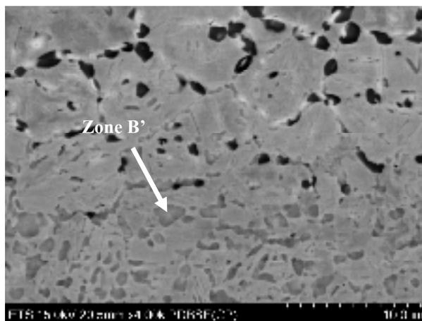
Figure 3.12 Image FEG en BSE de la zone B' d'un joint de BNi-2 brasé 150 minutes
