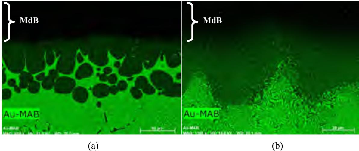
Figure 3.29 Cartographies FEG de la présence d'or à l'interface (a) d'un joint de BAu-4 brasé 15 minutes et (b) d'un joint BAu-6 brasé 150 minutes, montrant la non-diffusion de l'or dans le métal de base
