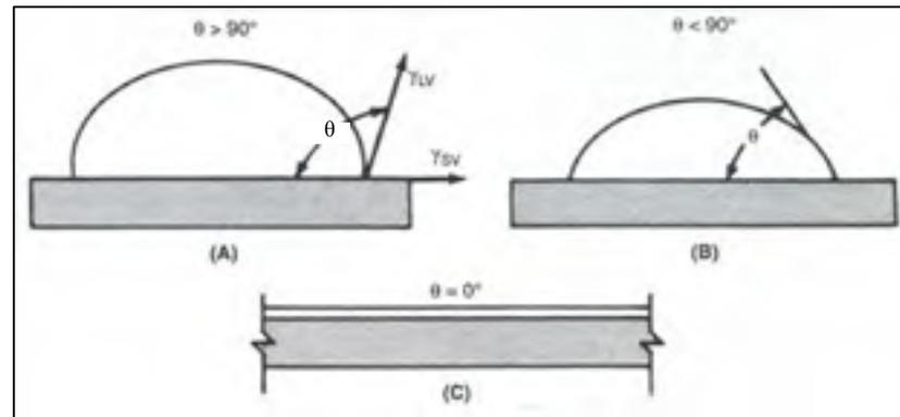
Figure 1.4 Différents cas de mouillage : (A) Mouillage nul, (B) Mouillage partiel, (C) Mouillage parfait (adapté de AWS, 2007)
