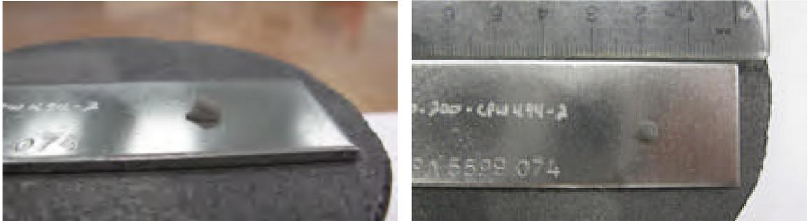
Figure 2.1 Dépôt de pâte sur la plaquette-échantillon avant brasage
