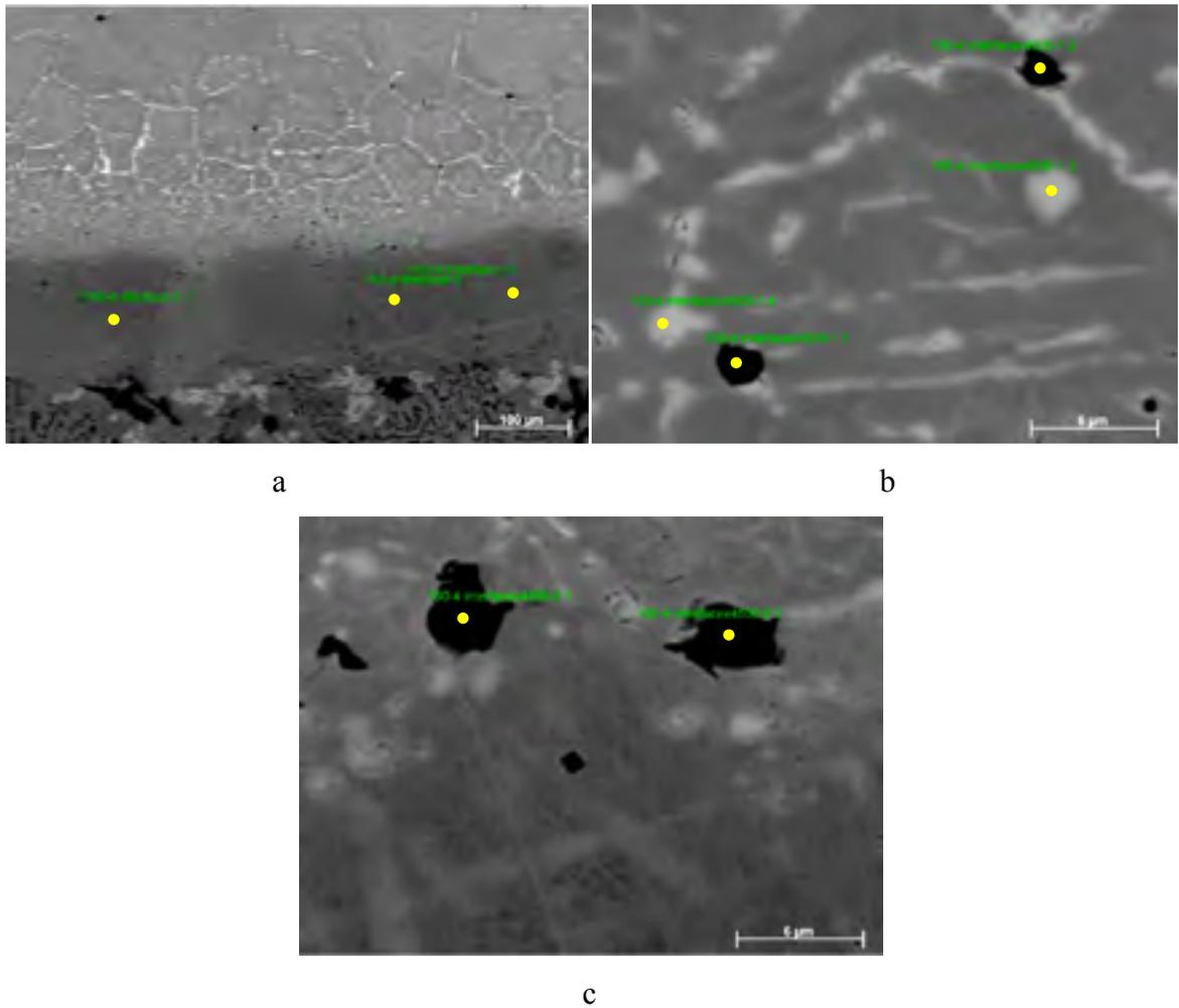
Figure-A VIII-1 Image FEG des pointés d'analyses chimiques de la zone d'interface et de diffusion d'un joint de BNi-1a brasé 150 minutes
