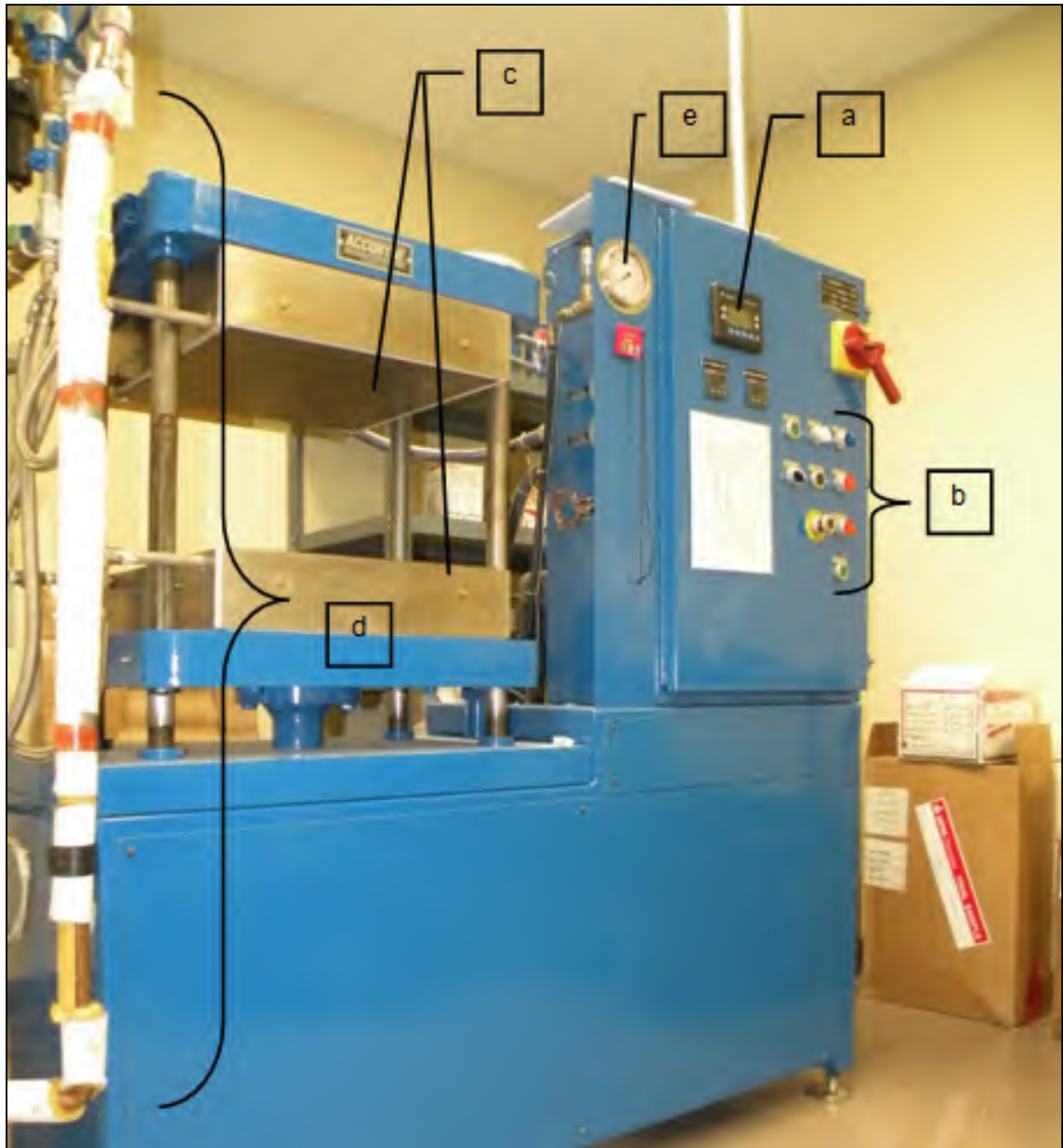
Figure 2.7 Presse chauffante hydraulique 10 tonnes à contrôleur de température. a) contrôleur de température, b) Commande de la presse, c) plaques chauffantes, d) circuit de refroidissement et e) jauge de pression
