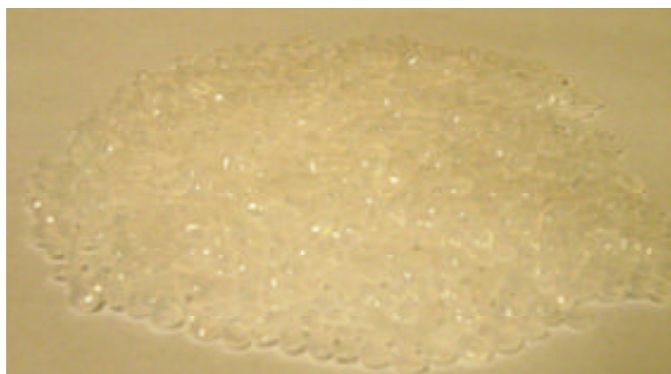
Figure 2.3 Pastilles d'agent compatibilisant M603 fournies par DuPont
