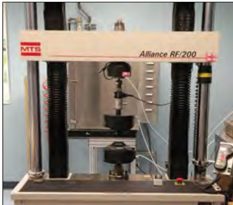
Figure 2.10 Équipement de traction à grand déplacement MTS Alliance RF/200
