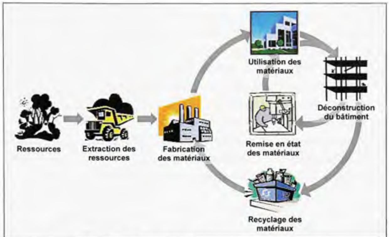
**Figure 2.2** Cycle de vie des matériaux – Approche à boucle fermée.
