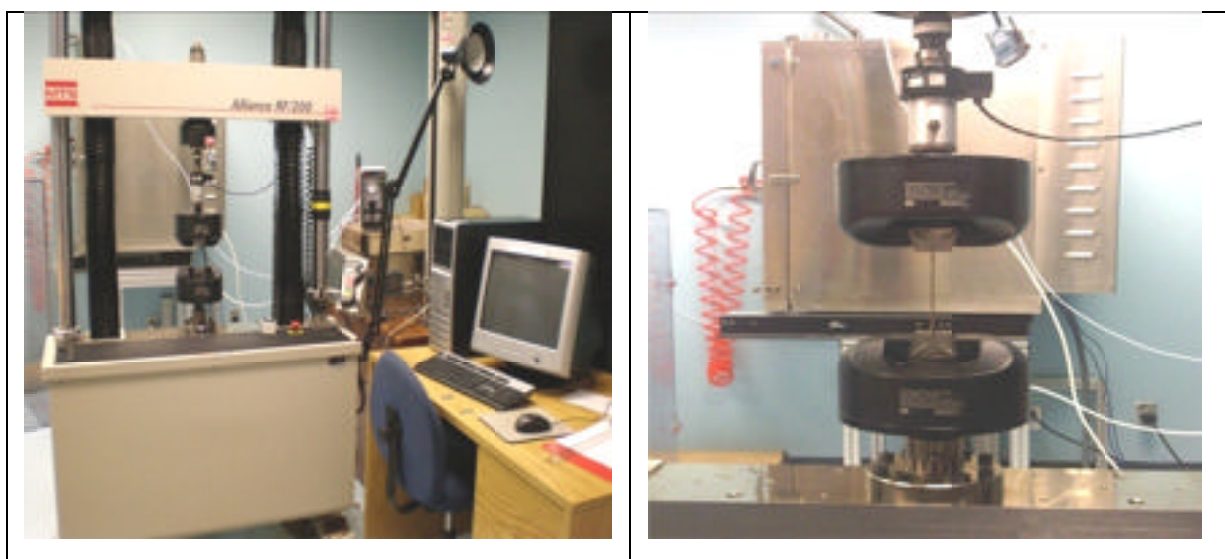
Figure 2.6 Équipement pour les tests à gauche et éprouvette dans les mâchoires du Material test systems à droite
