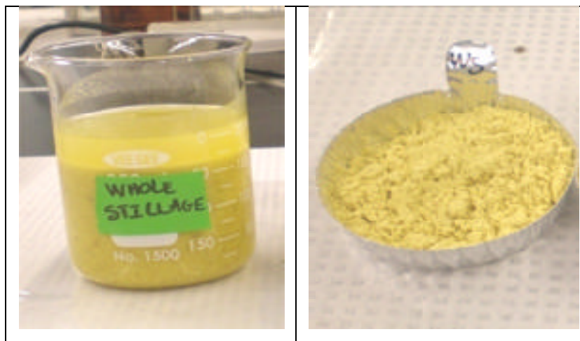
Figure 2.2 Whole stillage avant la lyophilisation à gauche et après la lyophilisation et le broyage à droite
