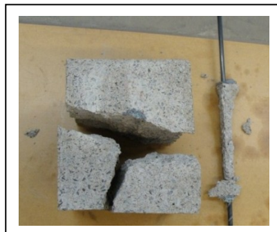
Figure 5.9 Rupture sur l'interface béton/époxy
