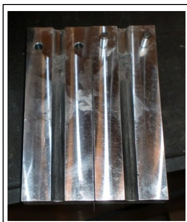
Figure 4.9 Plaque de protection contre les Mâchoires de la machine d'essai
