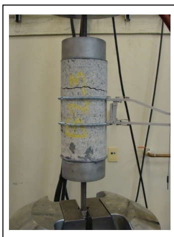
Figure 4.5 Essai de traction sur le béton
