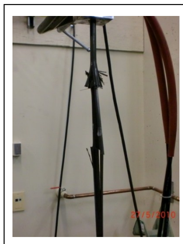
Figure 4.11 Rupture d'une barre en CFRP soumise à la traction
