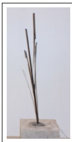
Figure 5.6 Rupture de la barre en CFRP
