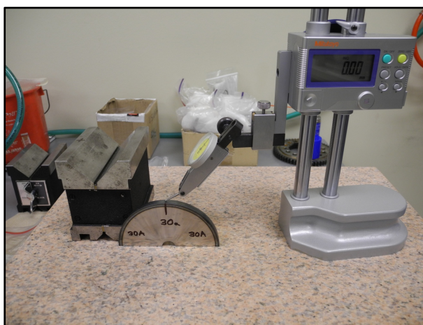
Figure 3.9 Montage utilisé pour la mesure de profondeur après polissage
