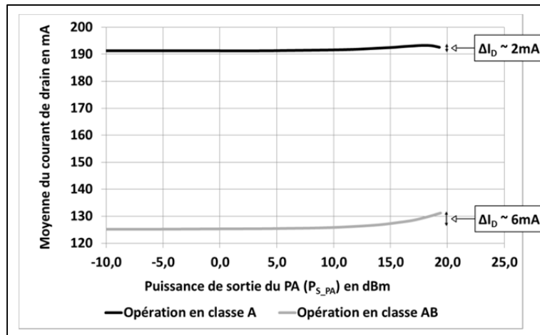
Figure 4.8 Mesure de la variation du courant moyen en fonction de la puissance RF de sortie en classe A et en classe AB
