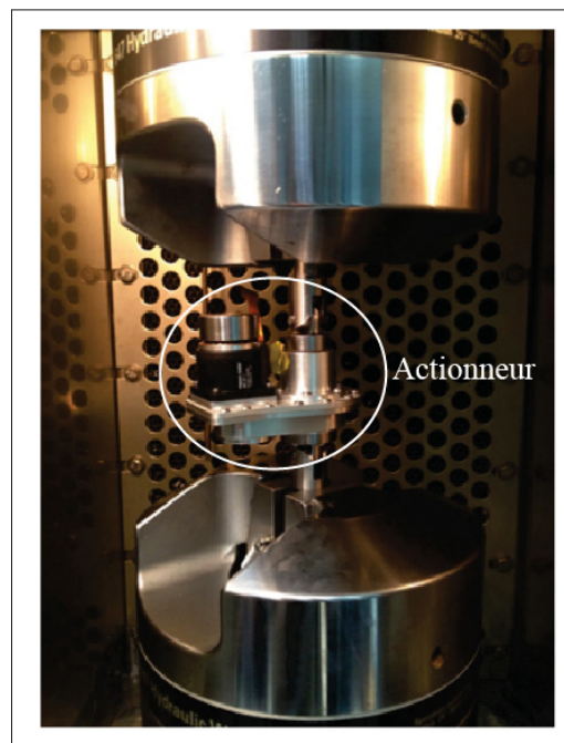
Figure 4.4 Actionneur installé dans la machine de traction.
