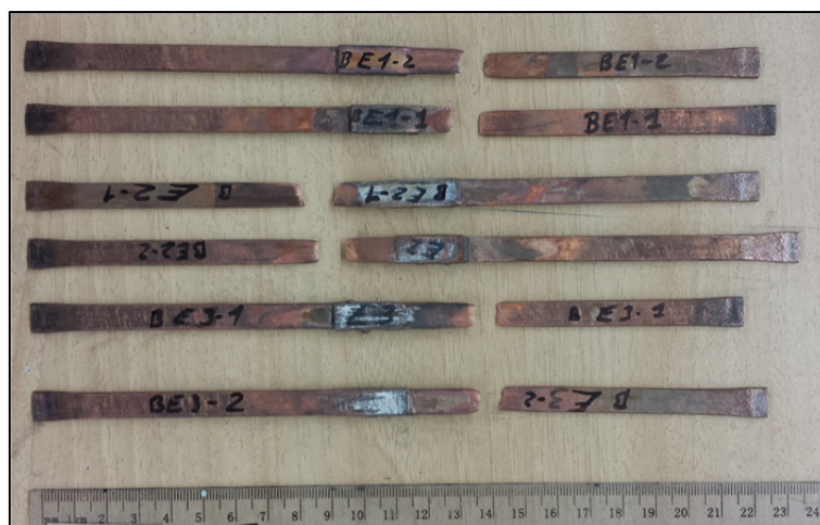
Figure 4.1 Résultats des essais de traction pour une longueur de recouvrement de 20 mm
