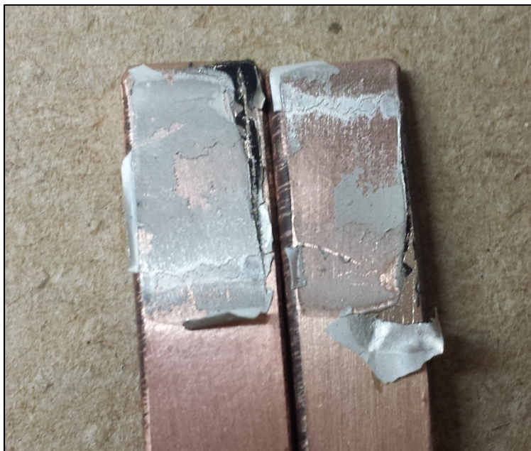
Figure 4.22 Photographie de la surface de rupture d'un joint fritté sous argon à 750°C pendant 15 minutes
