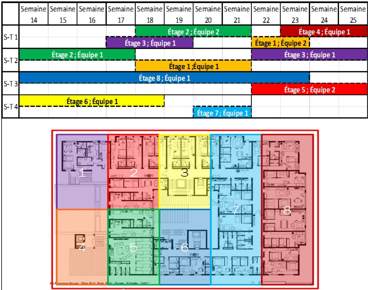
Figure 3.4 Combinaison d’un plan d’étage et d’un échéancier Gantt modifié adaptée de Prats (2016)
