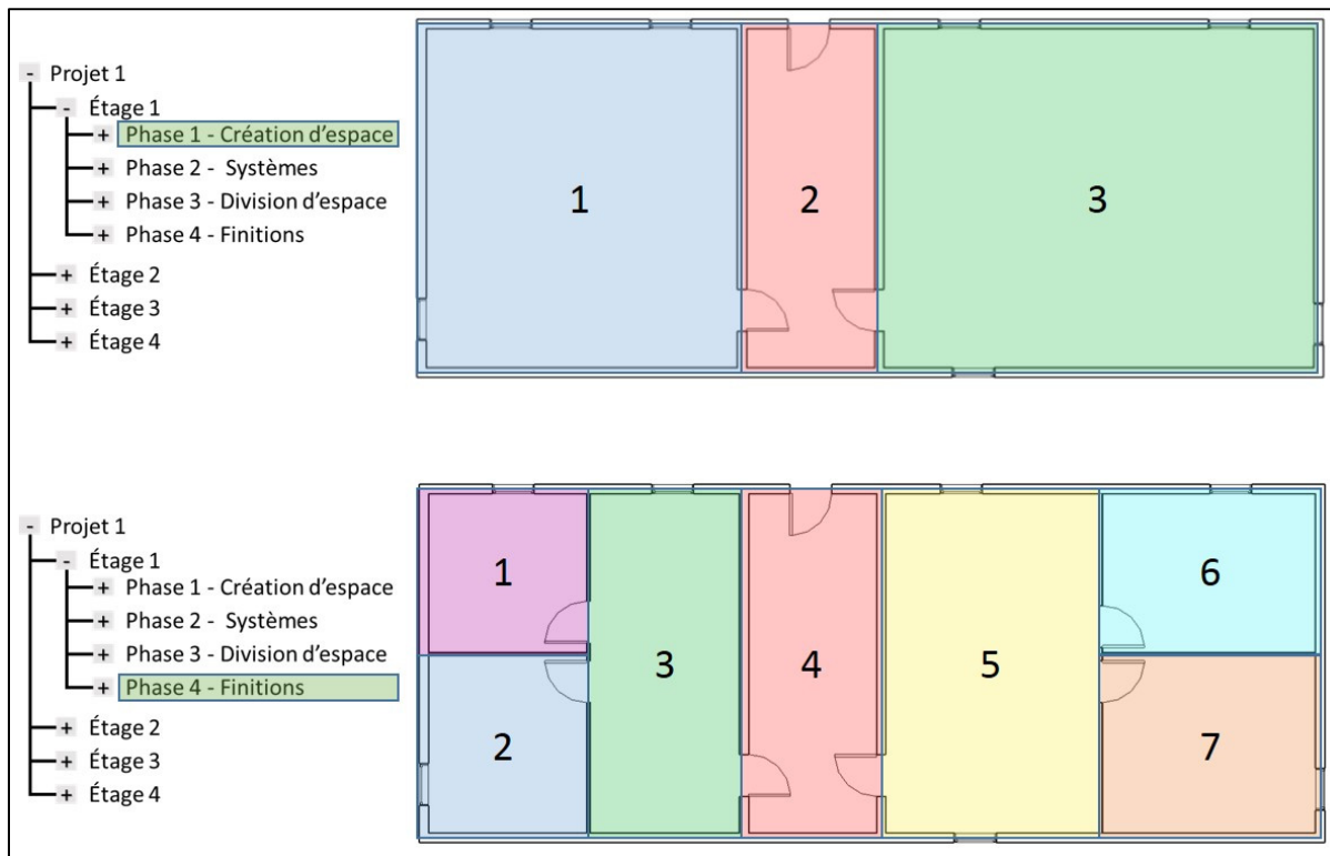
Figure 3.1 Illustration du LBS, zones de la phase Création d'espaces (en haut) et de la phase Finition (en bas)
