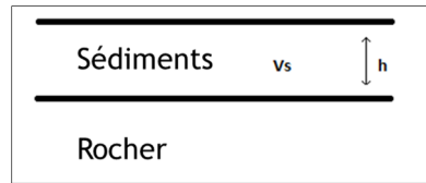
Figure 1.3 Schéma d'un modèle à une dimension de couche sédimentaire recouvrant le socle
