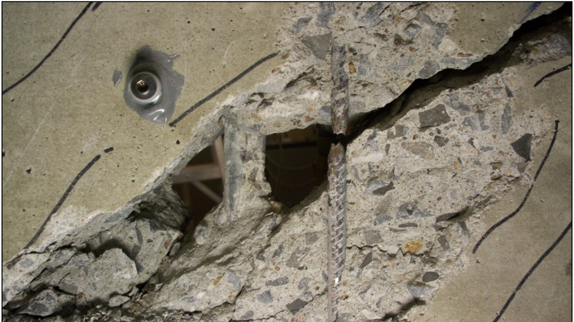
Figure 11.5 Rupture après plastification d'un étrier dans le spécimen S3-FE.
