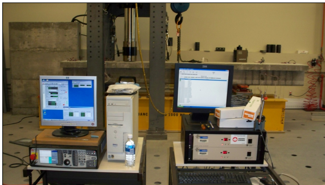
Figure-A II-21 Système de gestion du chargement et d'acquisition des données.
