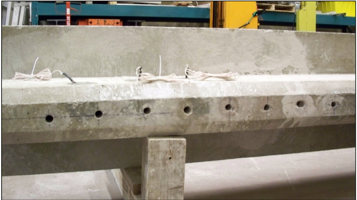
Figure-A II-6 Poutre percée pour l'implantation de la méthode ÉTS.
