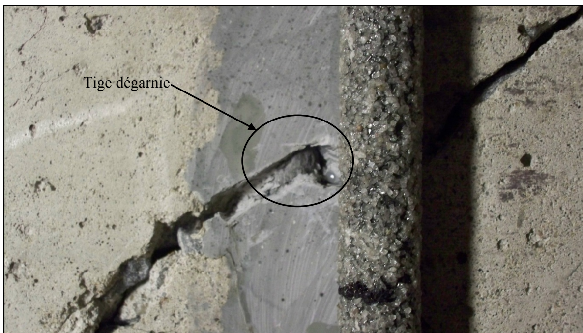
Figure 12.1 Perte d'adhérence entre la barre et son enrobage de sable.
