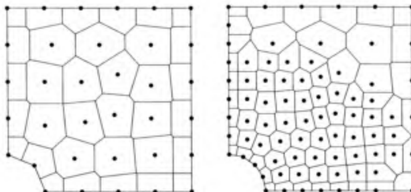
Figure 20 Exemple d'adaptativité dans le cas d'un problème d'élastostatique d'après Yvonnet [48]
