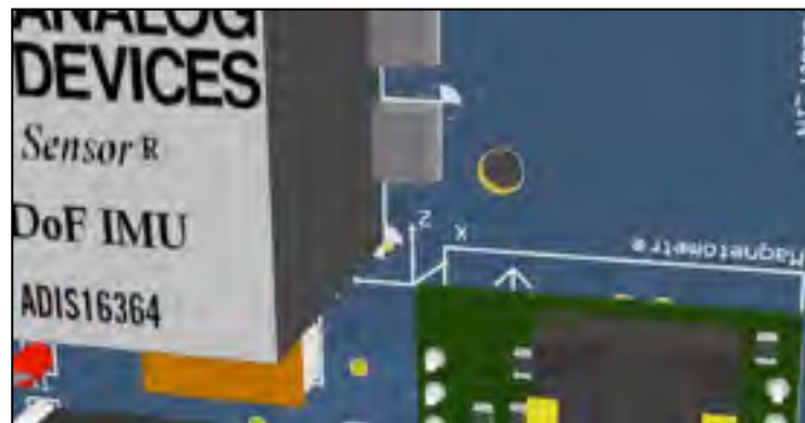
Figure 5.12 Marque indiquant où placer la carte par rapport au CM du drone
