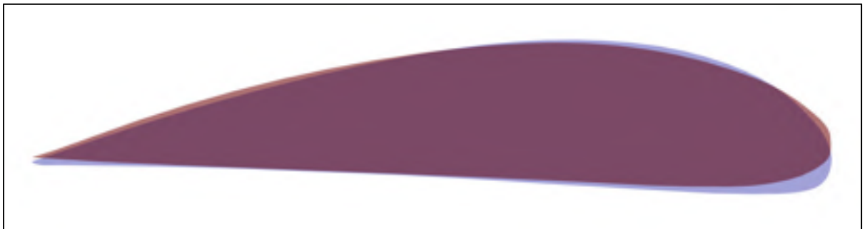
Figure 3.28 Comparaison du profil du NexSTAR (en rouge) avec le U.S.A.-35A (en bleu et plus cambré)
