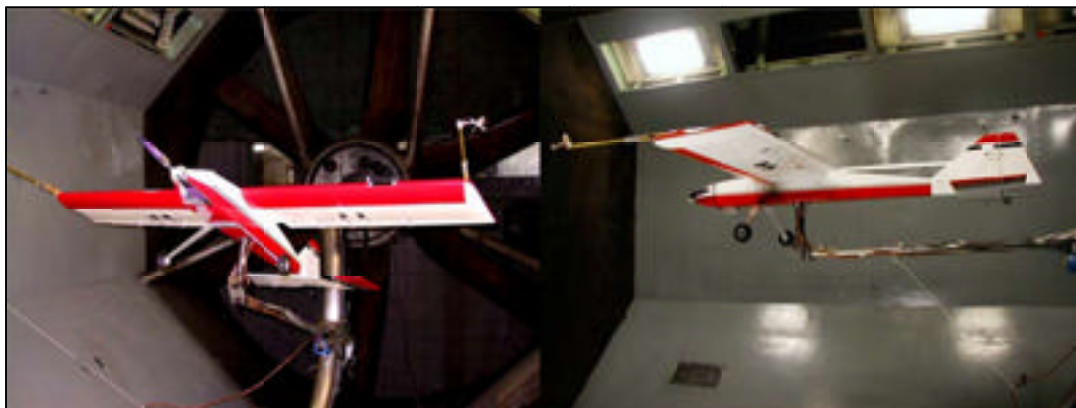
Figure 3.26 Le FASER dans la soufflerie basse vitesse de 12 pieds au centre de recherche de la NASA à Langley Tirée de Morelli et DeLoach (2003, p. 12)
