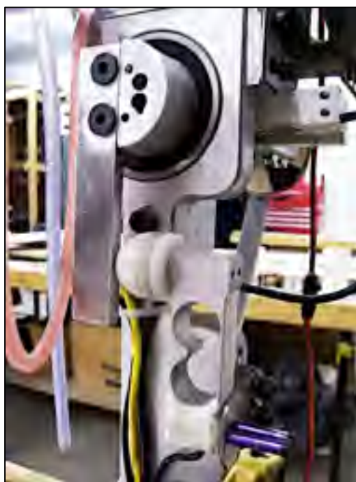
Figure 3.10 Gros plan sur la cellule de charge qui mesure le moment causé par la traînée de l'hélice
