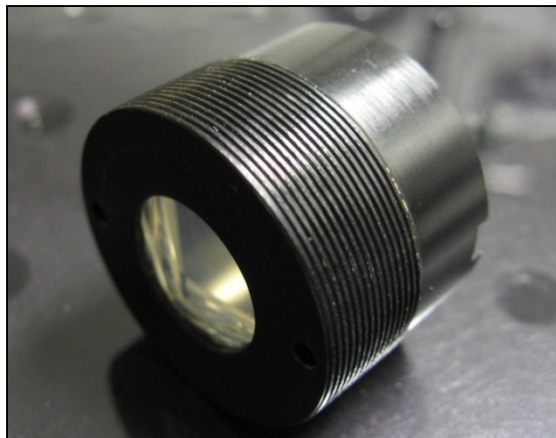
Figure 2.1 Filtre supprimeur fixe
