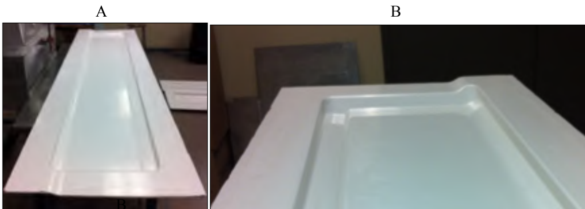
Figure 3.12 Moule pour la fabrication de l'intrados. A) Vue d'ensemble. B) Agrandissement de la zone de moulage
