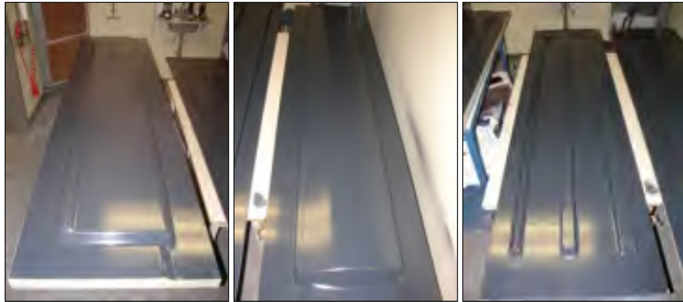
Figure 3.8 Modèles pour la fabrication des longerons, de l'extrados et l'intrados après le polissage du fini de surface à base de polyester
