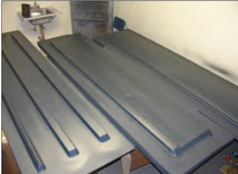
Figure 3.7 Modèles pour la fabrication des longerons, de l'extrados et l'intrados après l'application du fini de surface à base de polyester
