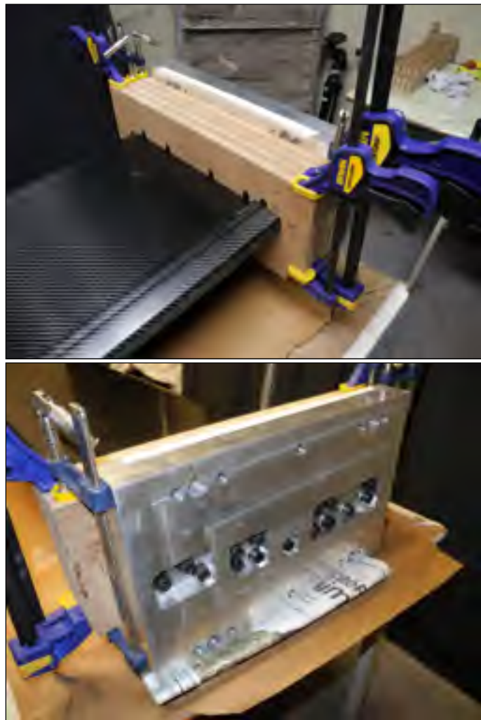
Figure 3.37 Collage des nervures en aluminium pour la fixation au gabarit de flexion
