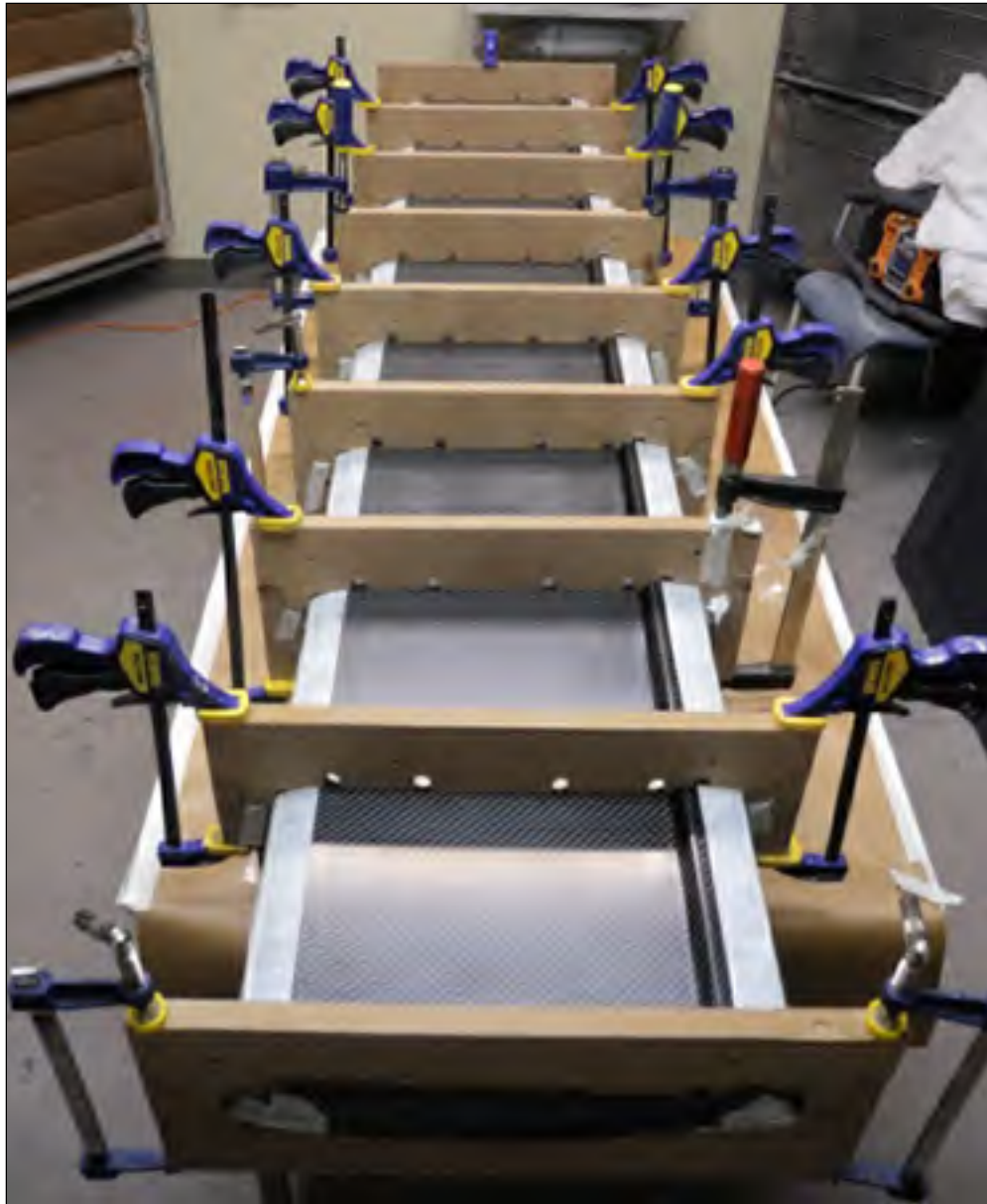
Figure 3.35 Collage de l'extrados. Fermeture à l'aide des gabarits de collage
