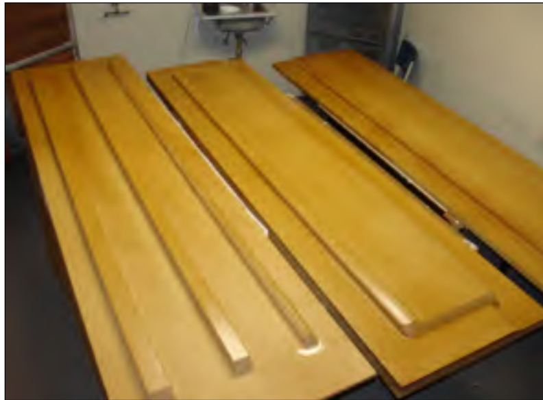
Figure 3.6 Modèles pour la fabrication des longerons, de l'extrados et l'intrados après l'application du scellant
