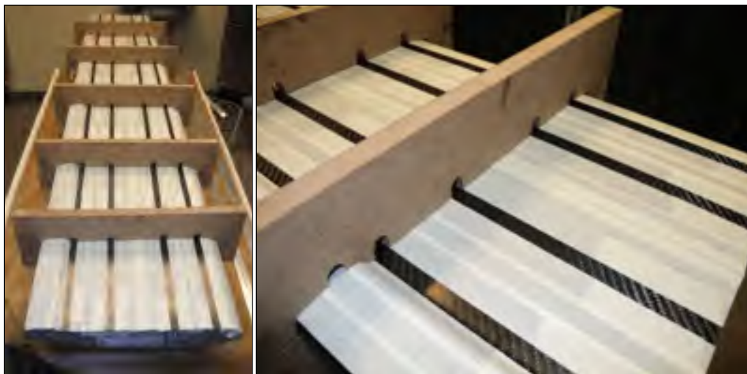
Figure 3.39 Positionnement du ruban à masquer pour protéger la surface de l'extrados lors du collage
