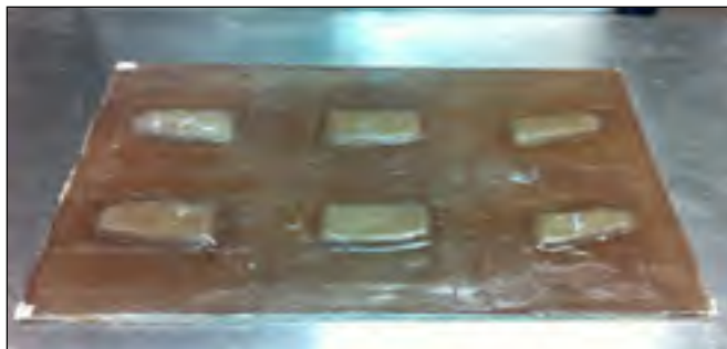
Figure 3.10 Structure du moule en fibres de verre mats/polyester pour la fabrication des nervures
