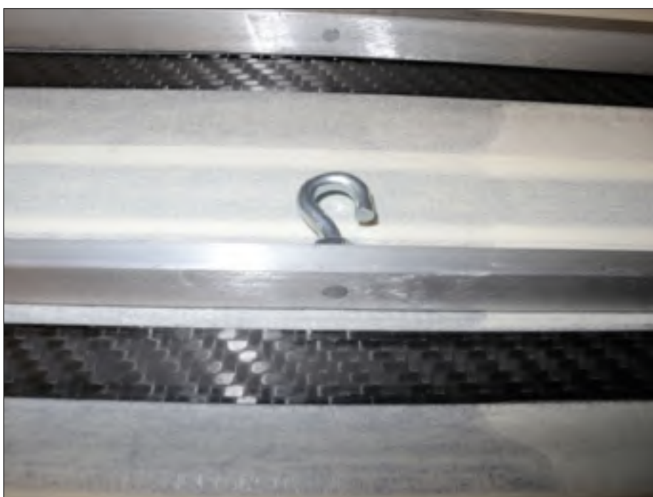
Figure 3.40 Extrusion et crochets de fixation après le sablage des surfaces de collage
