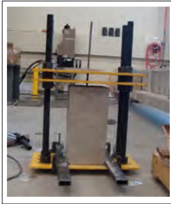
Figure-A I-1 Système d'alignement de la mèche avec l'axe Vertical du bloc en béton
