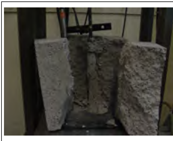
Figure 5.1 Rupture par éclatement du béton
