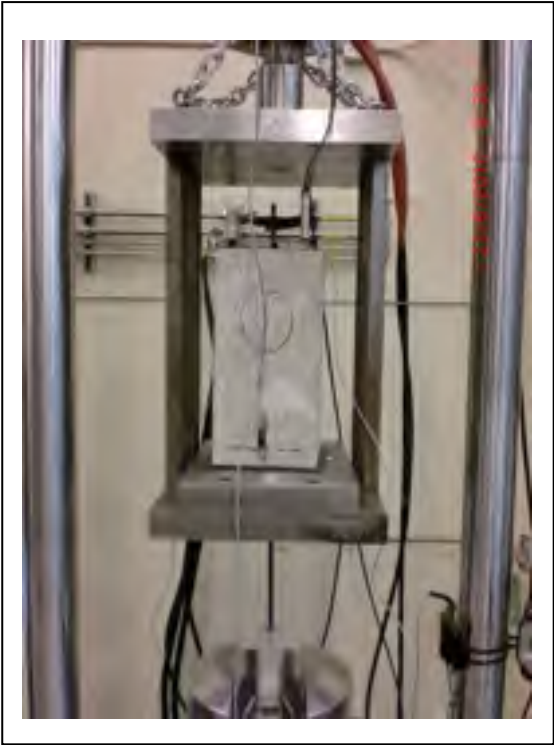
Figure 4.16 Spécimen prêt pour l'essai d'arrachement
