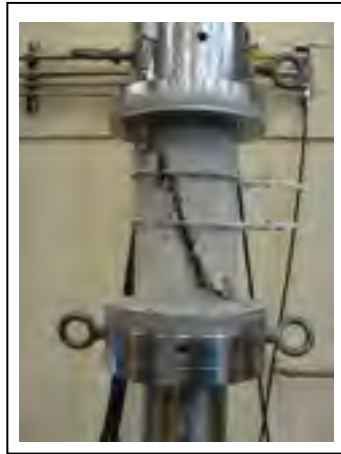
Figure 4.4 Essai de compression sur le béton
