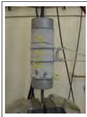
Figure 4.5 Essai de traction sur le béton
