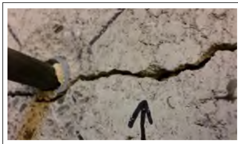
Figure 5.13 Fissuration d'un spécimen d'essai
