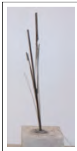
Figure 5.6 Rupture de la barre en CFRP
