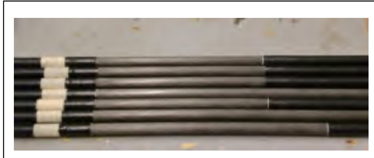
Figure 4.12 Barres en CFRP prête à l'usage
