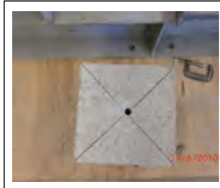
Figure 4.8 Bloc de béton après perçage
