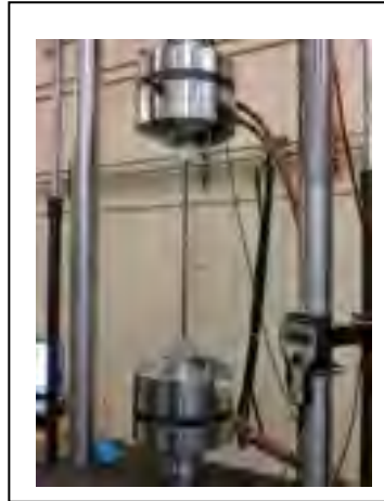
Figure 4.10 Mise en essai d'une barre en CFRP
