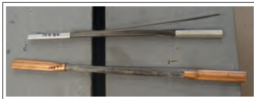
Figure-A I-2 Essai de différentes techniques de protection de la tige en CFRP contre les grappes de la machine d'essai
