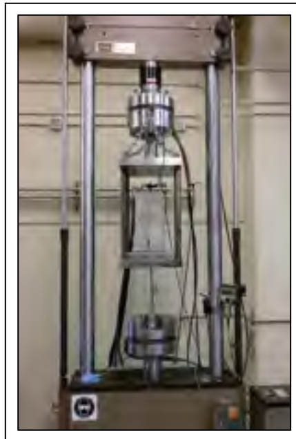
Figure 4.2 Machine d'essai de traction
