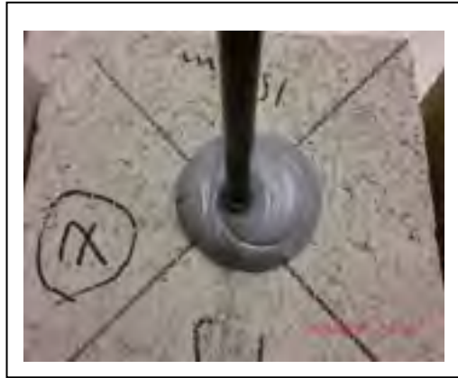
Figure 4.13 Insertion de la tige en CFRP dans le Bloc de béton
