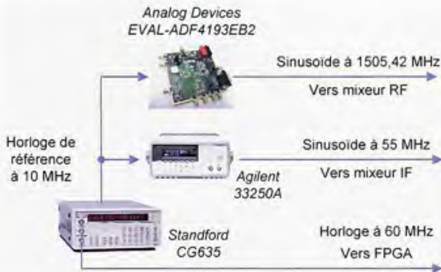
Figure 3.17 Schéma de branchement des horloges et LO.
