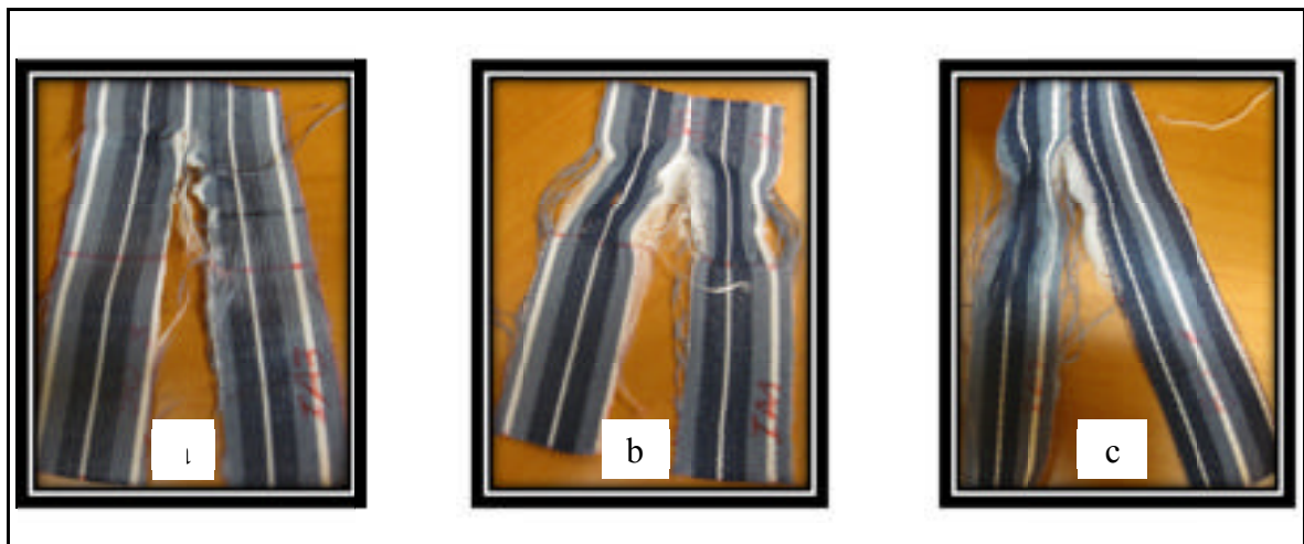
Figure 2.19 Mécanismes de déchirure des structures textiles en polyester, issus des essais de déchirure pantalon : a) déchirure par rupture des fils transversaux avec faible glissement des fils transversaux; b) déchirure par glissement/rupture des fils transversaux; c) déchirure par glissement des fils transversaux (sans rupture)
